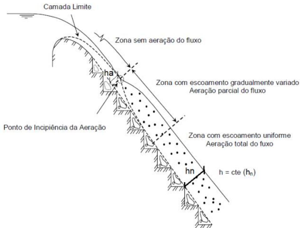
Figura 4 - Desenvolvimento da aeração em uma calha em degraus. Fonte: adaptado de Chanson (1994a)
