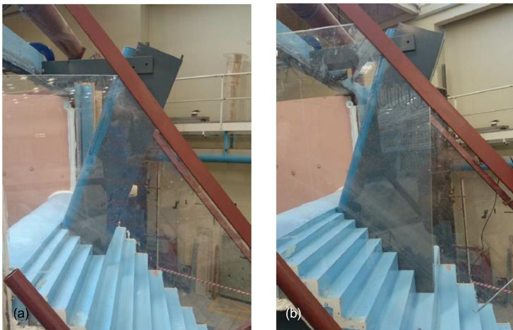
Figura 28 – Pilares instalados no modelo físico de vertedouro em degraus do estudo de Calitz (2015) (a) Pilar Tipo 1 e (b) Pilar Tipo 2. Fonte: adaptado de Calitz (2015).
