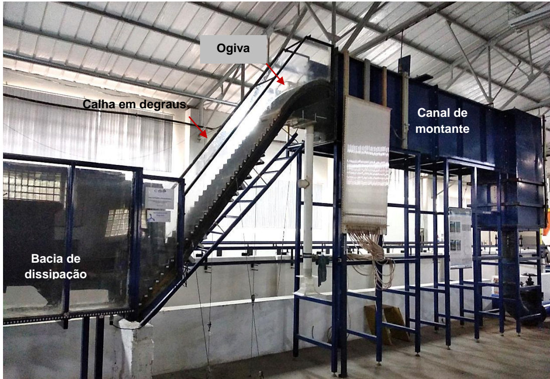
Figura 36 – Vista geral do modelo físico do vertedouro em degraus instalado no LOH
