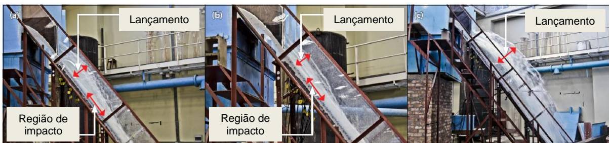
Figura 33 – Comparação do escoamento para a vazão específica de 50 \text{ m}^3/\text{s}/\text{m} para o vertedouro em degraus com (a) pilar FGP-Y, (b) pilar FGP-X e pilar FGP-Y + defletor. Fonte: adaptado de Koen, Bosman e Basson (2019)
