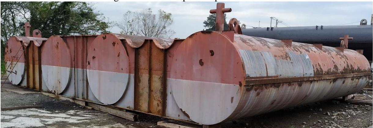
As etapas necessárias entre a situação inicial da balsa até sua disponibilidade para operação estão descritas como reforma. A reforma da balsa inclui as etapas de desmontagem, transporte, montagem, preparação da superfície, pintura, montagem das proteções exteriores e assessoria técnica.
