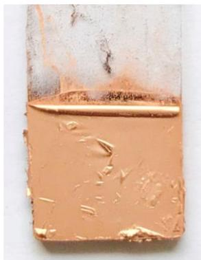
*Figura 20 - Amostra de GO/Au NPs após o processo de deposição sem corrente em banho de Cu.*
