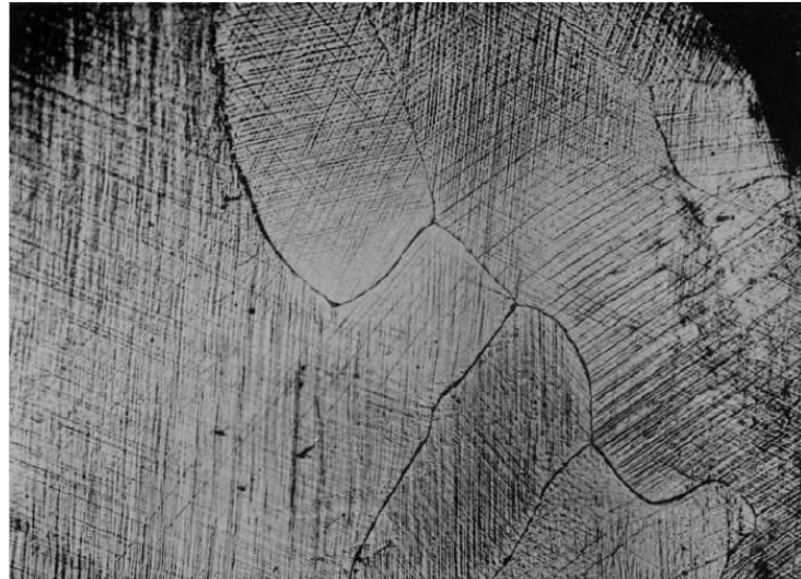
Figura 2.9 – Micrografia óptica de metal policristalino deformado plasticamente (fonte: Ewing e Rosenhain (1900, p. 362))
