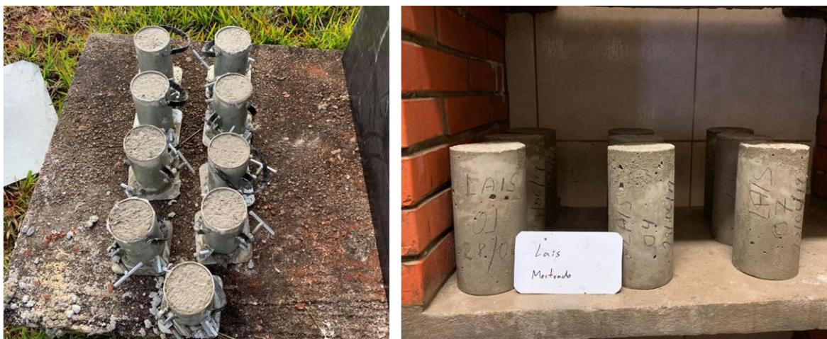
Figura 4.16: Corpos de prova de concreto moldados em campo
