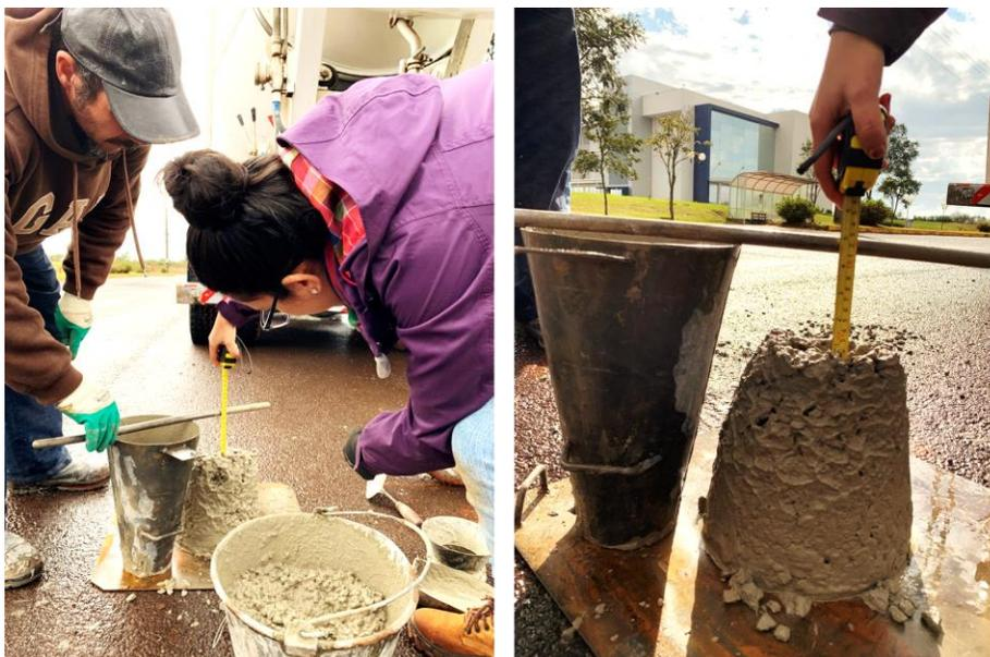
Figura 4.15: *Slump test* realizado em campo
