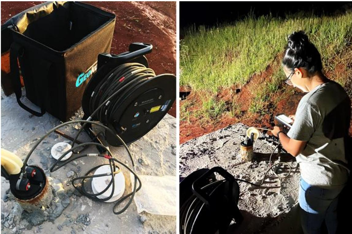
Figura 4.27: Operação do inclinômetro em campo
