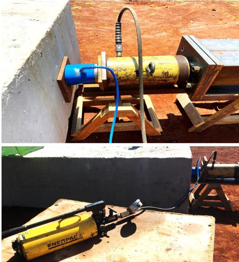
Figura 4.21: Sistema de aplicação e leitura de carga
