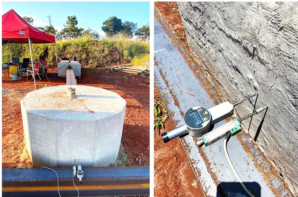
Figura 4.23: Medidores de deslocamento no topo
