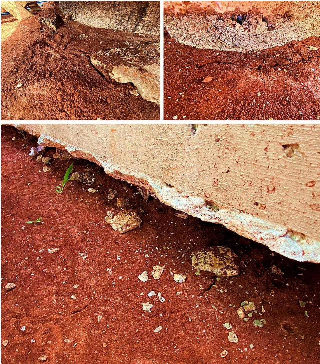
Figura 5.6: Vazio entre a estaca E2 do grupo e solo pela aplicação da carga final
