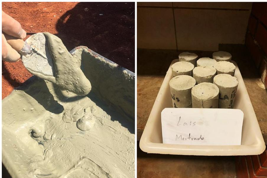
Figura 4.17: Corpos de prova da calda de cimento
