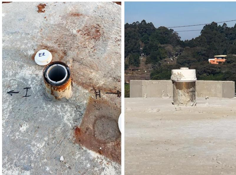
Figura 4.18: Posicionamento e alinhamento dos tubos de inclinômetro
