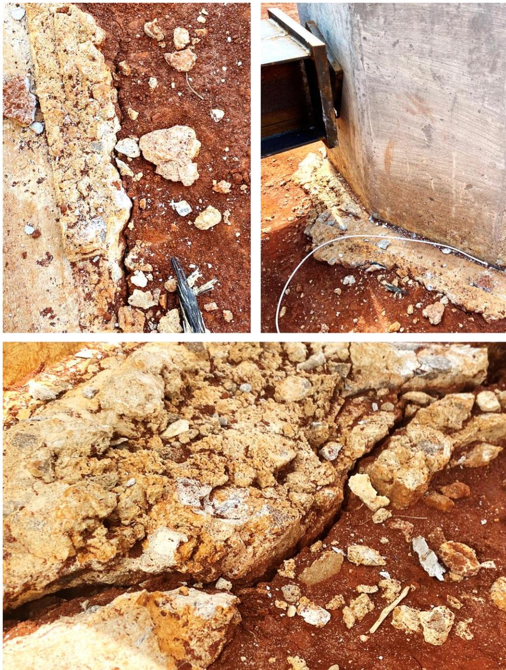
Figura 5.12: Vazio entre a estaca de reação e o solo pela aplicação da carga final
