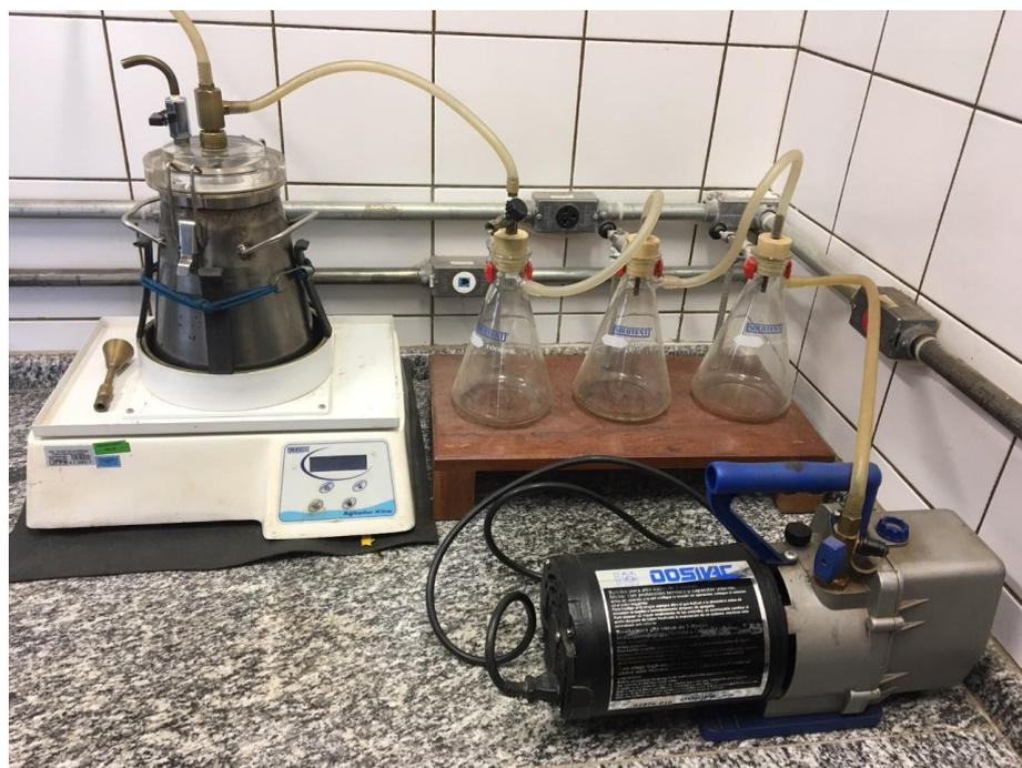
Figura 4.2: Equipamentos para ensaio Rice
