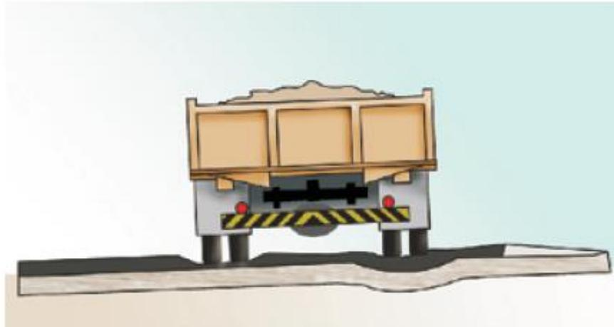
Figura 2.20– Deformações permanentes em pavimentos asfálticos (adaptado de BERNUCCI et al., 2010)
