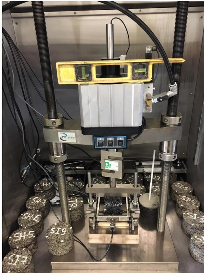
Figura 3.12: Ensaio de módulo de resiliência em execução
