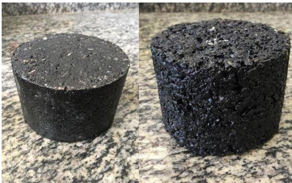
Figura 4.5: Corpo de prova de superfície lisa e porosa
