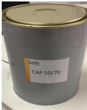
Figura 3.6: Latas de ligante asfáltico 50/70
