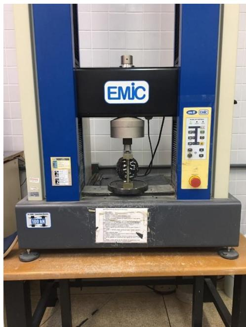
Figura 3.9: Prensa utilizada para resistência à tração diametral
