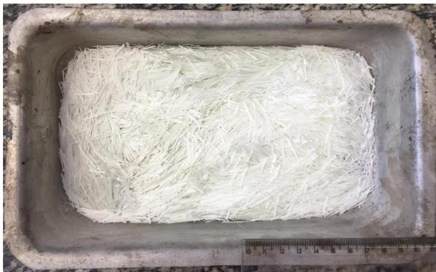
Figura 3.7 - Fibras de vidro utilizadas
