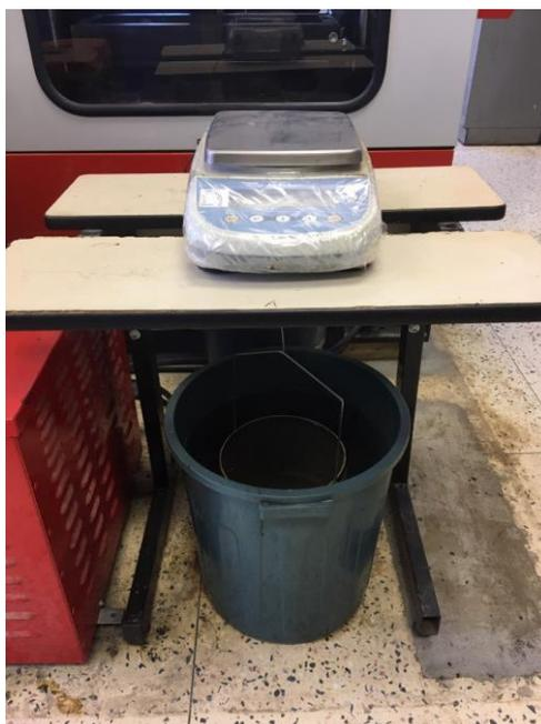
Figura 4.1: Balança hidrostática
