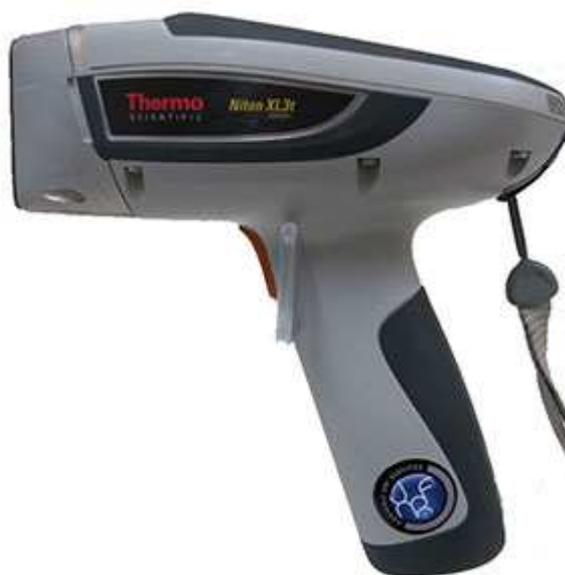
*Figura 18: Equipamento utilizado no ensaio de Fluorescência de Raio X.*
