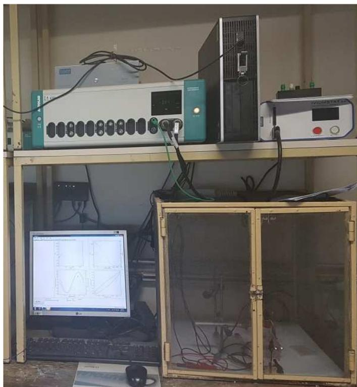
Figura 17: Potenciostato Autolab PGSTAT 302, utilizado para realização dos ensaios de espectroscopia de impedância eletroquímica. Adaptada de (62).
