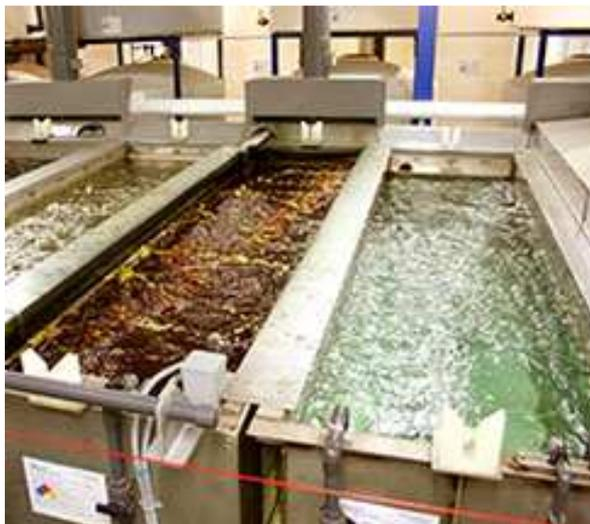
Figura 8: Tanques utilizados para realização dos banhos durante o processo de cromatização. Adaptado de (34).
