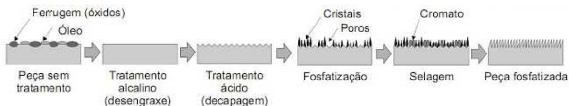
Figura 4: Processo de fosfatização. Adaptado de (24).
