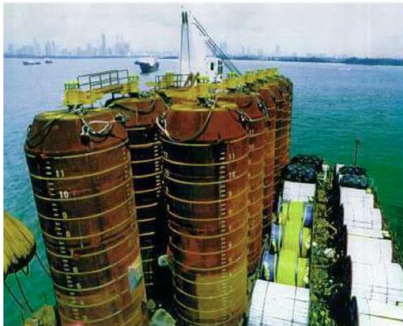
Figura 2.18: Estacas de sucção. (RANDOLPH et al , 2005).
