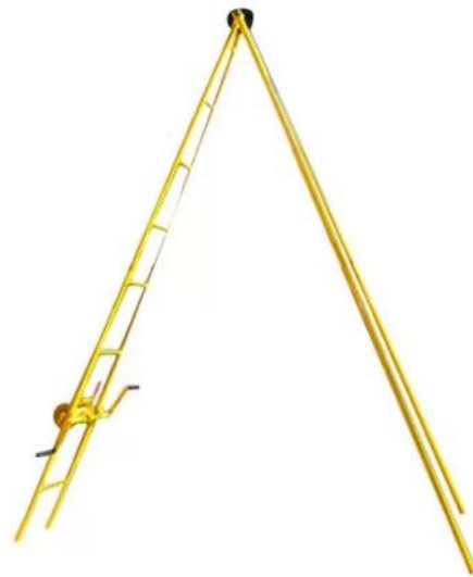
Figura 6.15: Tripé de sondagem SPT.
