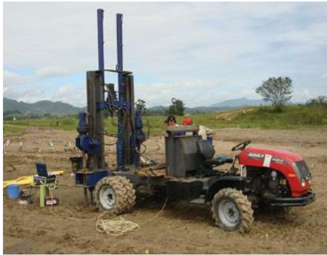
Figura 6.3: Sistema de cravação (SCHNAID, F.; ODEBRECHT, E., 2012).
