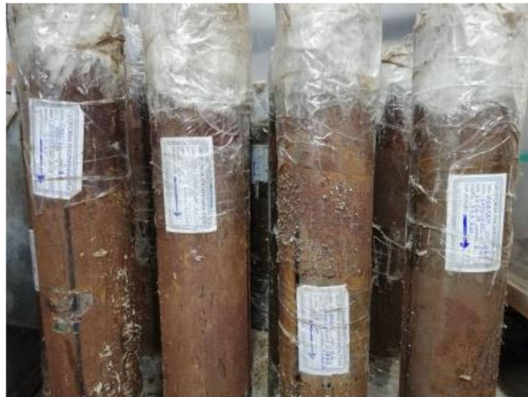
Figura 5.6: Tubos de Shelby com amostras coletadas em campo.
