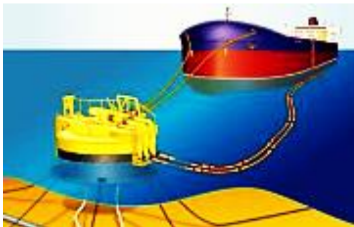
Figura 2.14: sistema CALM. (LIMA, D. A., 2011).
