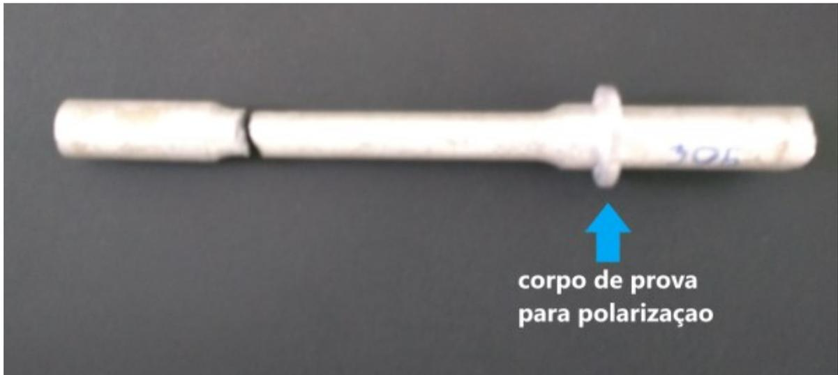
**Figura 39:** Corpo de prova da liga AA 413 fundido após ensaio de tração.
