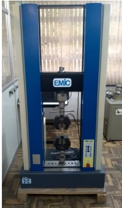
**Figura 25:** Máquina de ensaio de tração.
