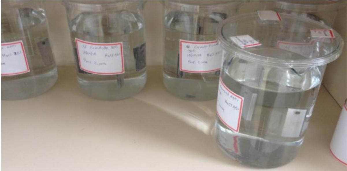
**Figura 38:** Corpo de prova em imersão das liga primária e secundárias de AA 413 e AA 6351-T6.
