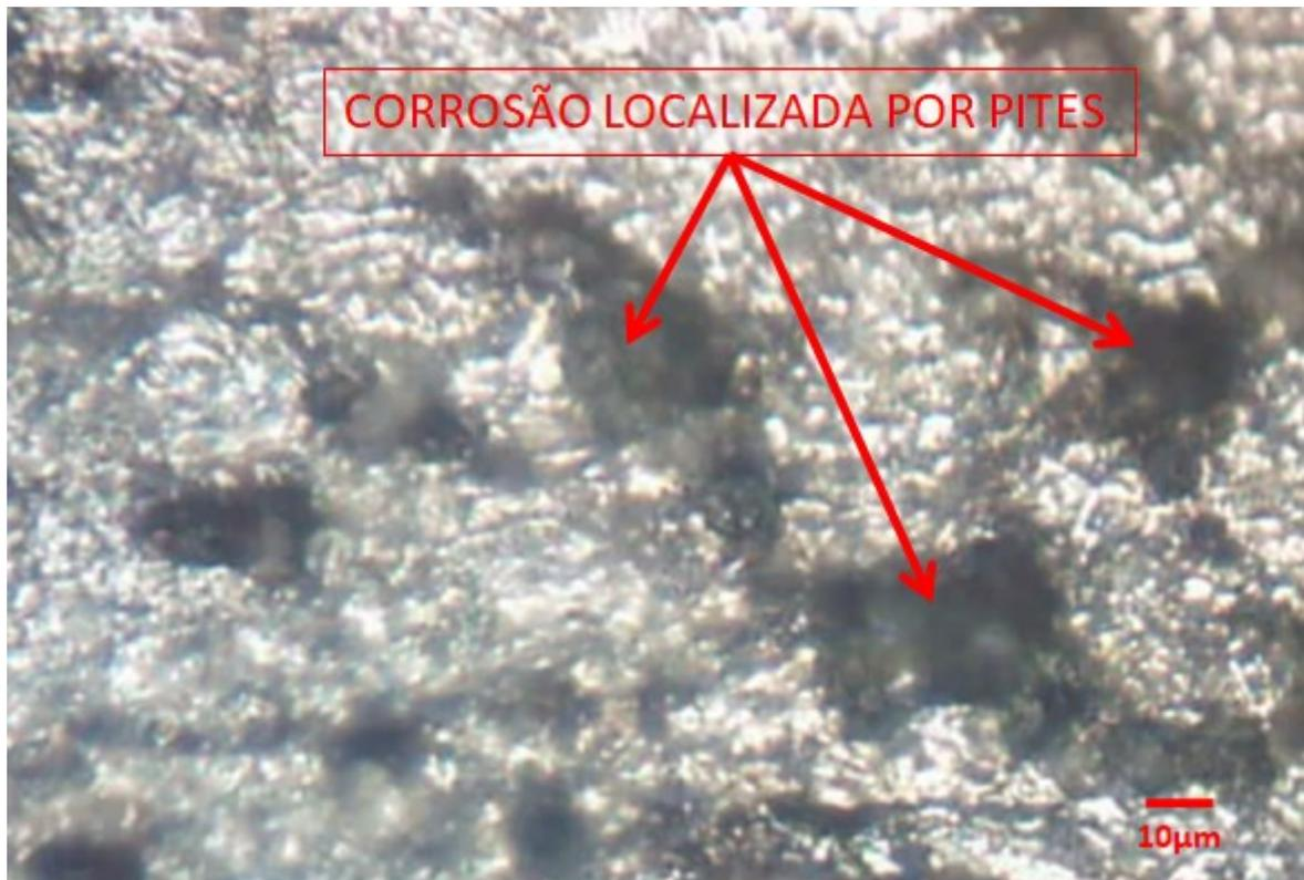
**Figura 62:** Corpos de prova dois de cavacos da liga AA 6351 após imersão compresença de pites.
