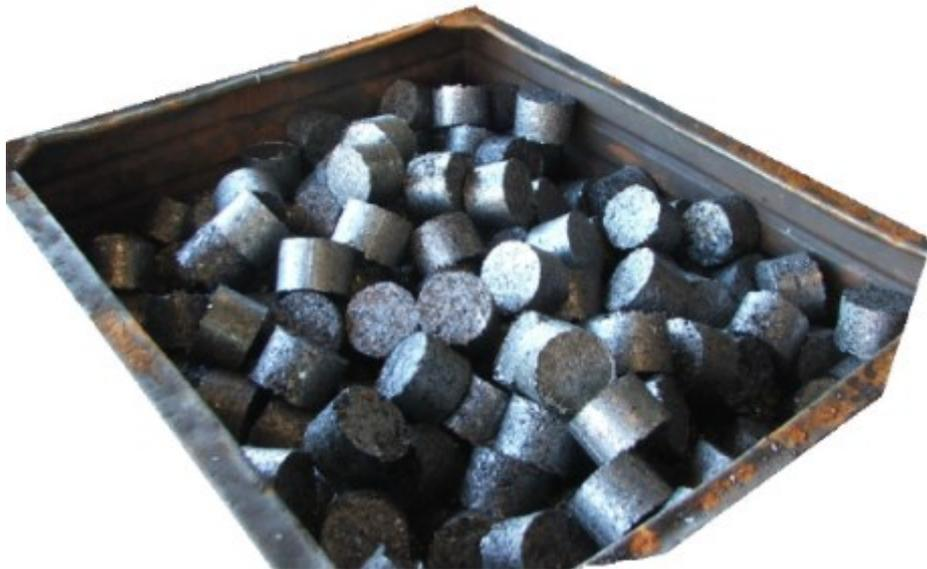
**Figura 8:** Briquetes de cavacos de Alumínio.<sup>(33)</sup>
