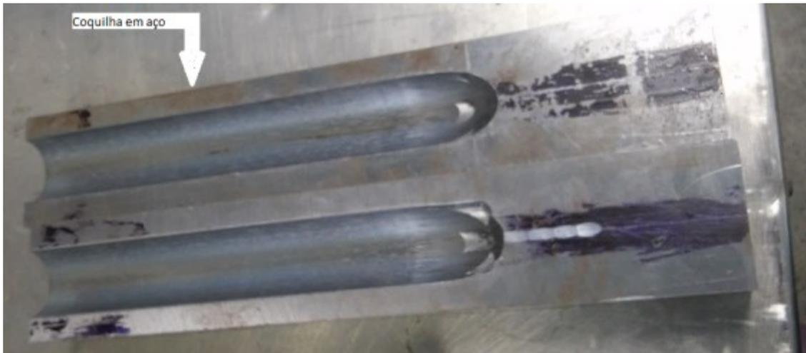
**Figura 27:** Representação da coquilha de aço usada no vazamento.
