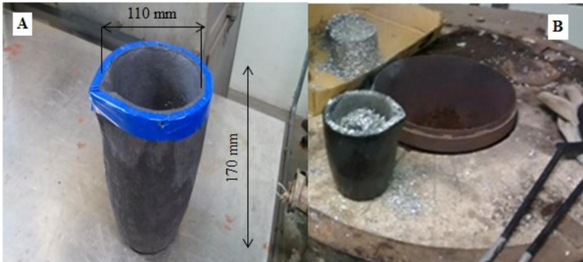
**Figura 21:** Carregamento do cadinho com os cavacos.
