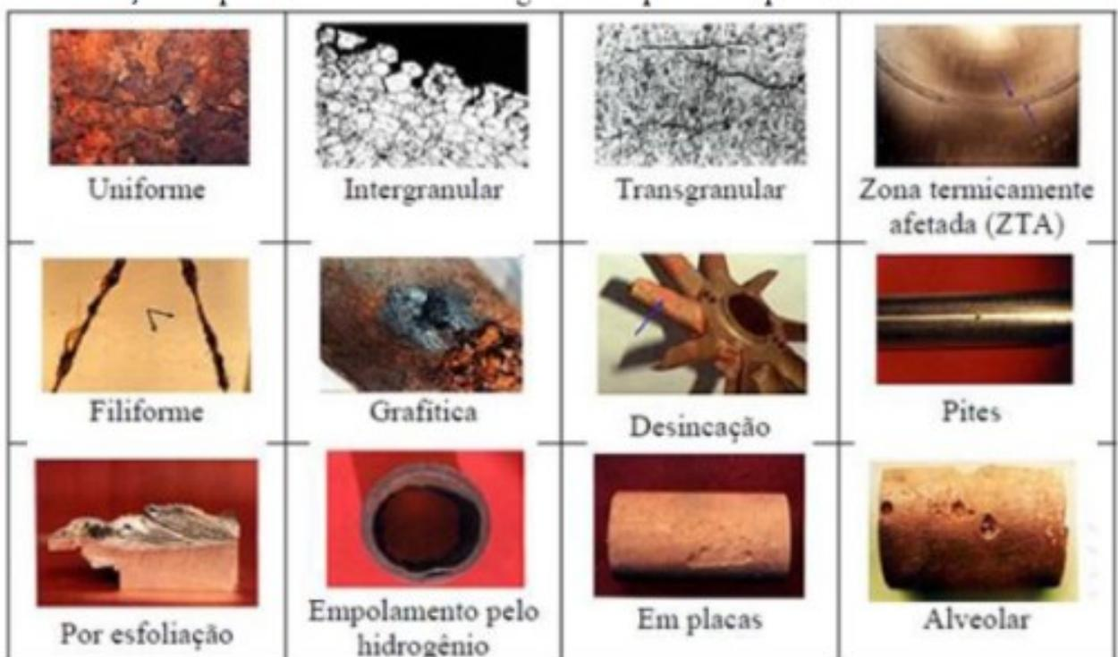
**Figura 13:** Classificação dos processos de corrosão segundo o tipo de ataque<sup>(45)</sup>
