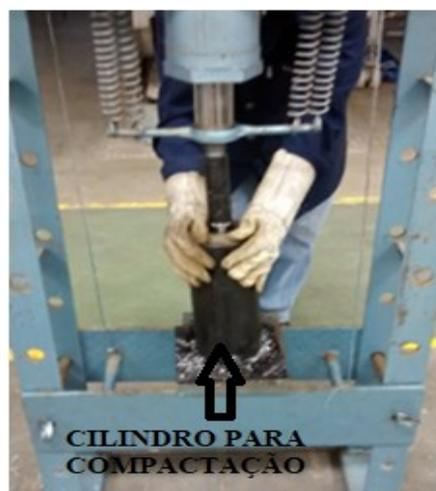
Figura 19: Cavacos sendo prensados.
