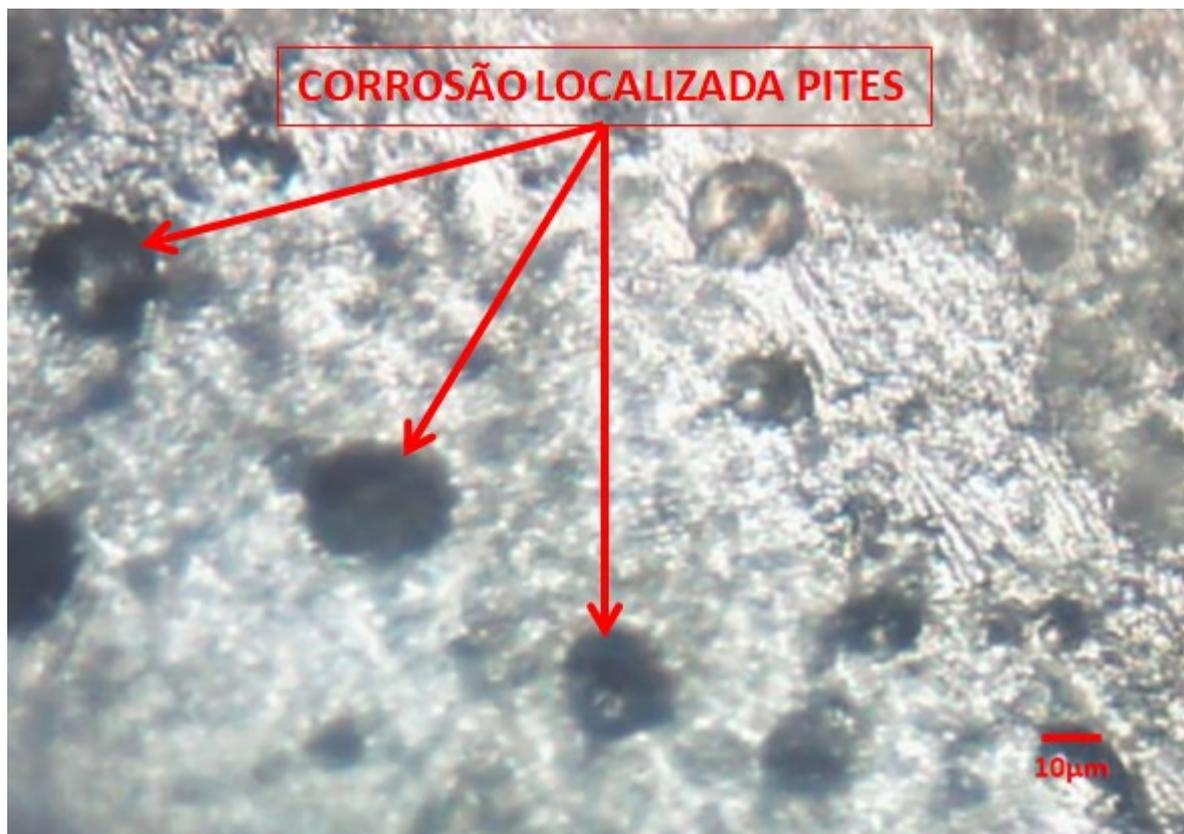
**Figura 60:** Corpos de prova três da liga AA 6351 fundido após imersão com presença de pites.
