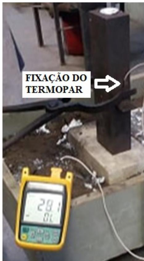
**Figura 23:** Sistema de monitoramento do vazamento.
