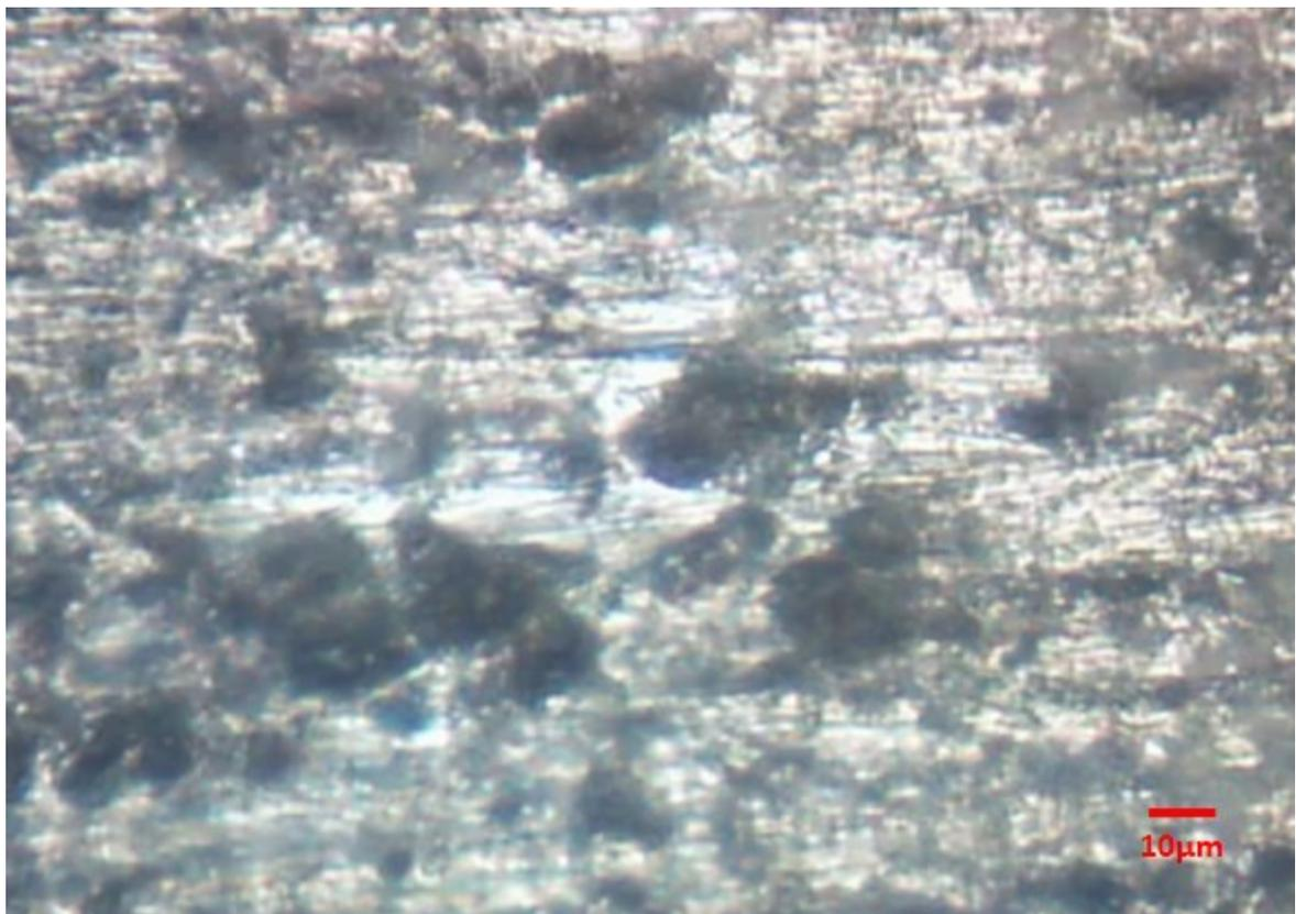
**Figura 58:** Corpos de prova três da liga AA 6351 comercial após imersão.
