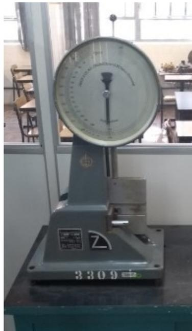
**Figura 32:** Máquina de ensaios Charpy.
