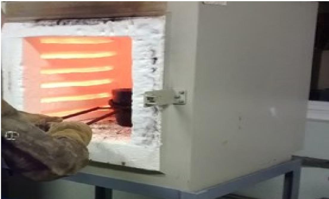
**Figura 22:** Carregamento do forno com os cavacos.
