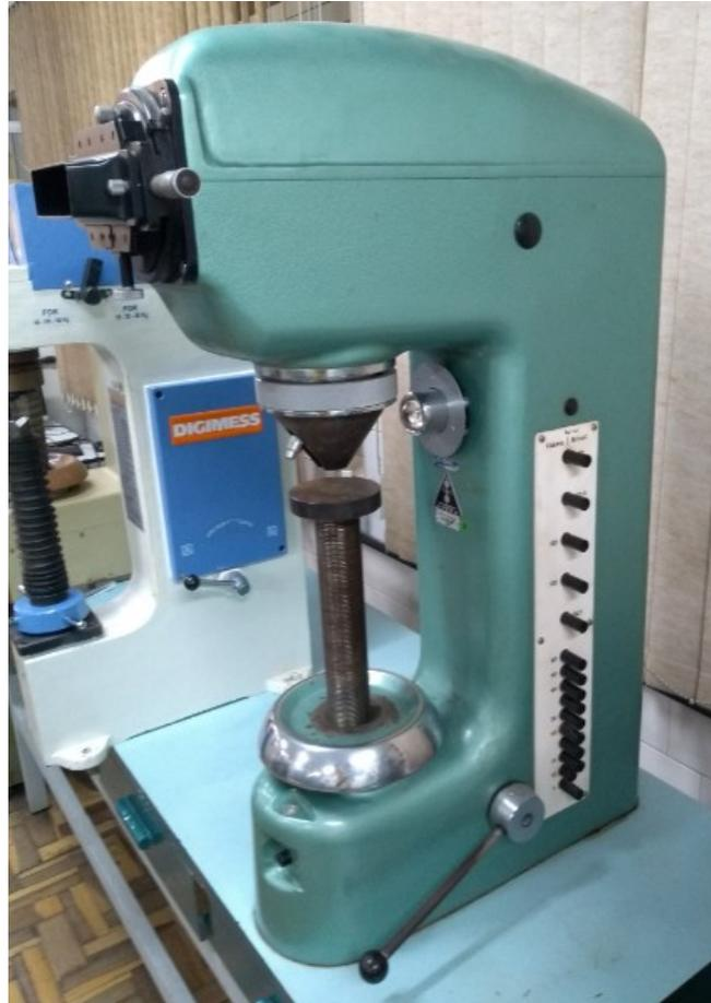
**Figura 29:** Máquina de ensaio de dureza.
