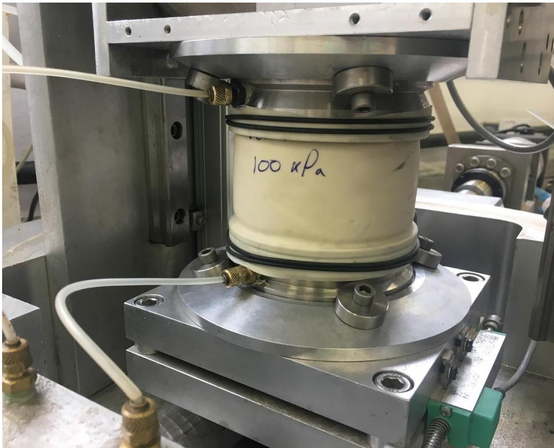
Figura 43 – Moldagem CP *simple shear*
