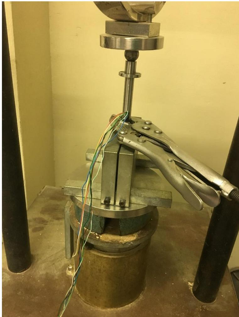
Figura 45 – Procedimento de calibração da célula de carga da ponta do minicone.
