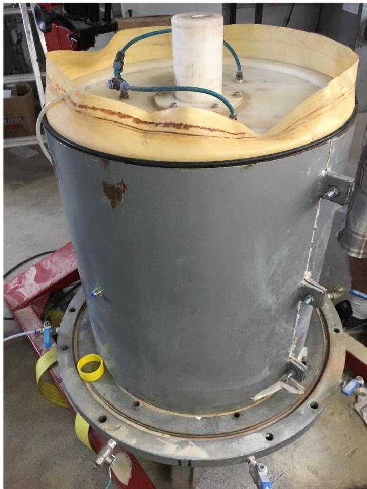
Figura 41 – Moldagem CP 500 x 500 mm
