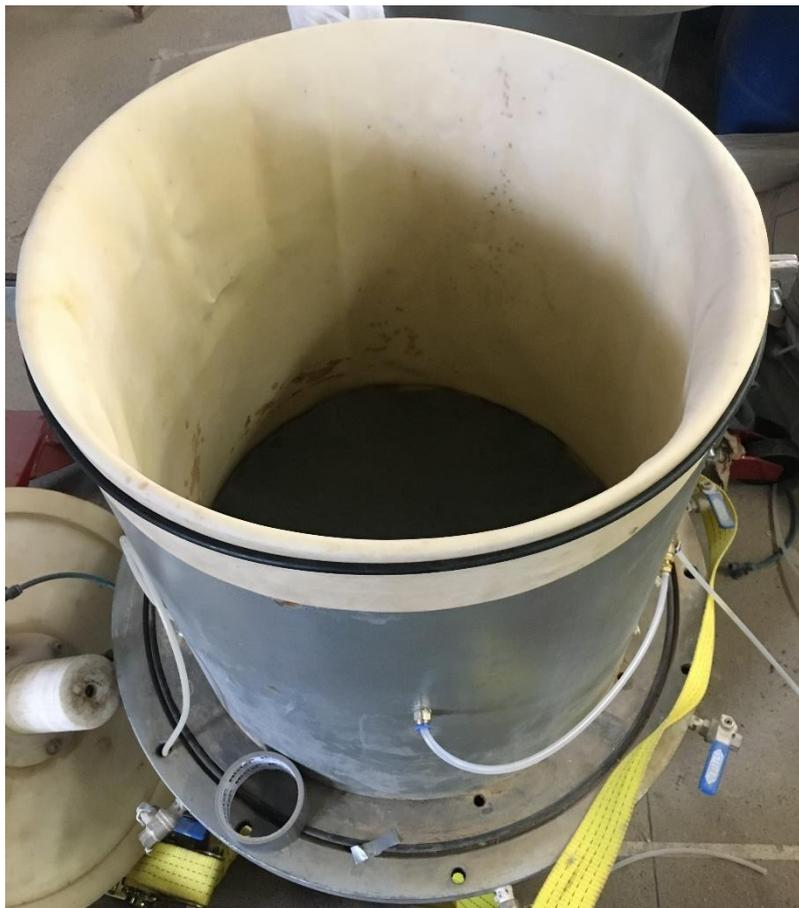
Figura 40 – Moldagem dos CPs 500 x 500 mm
