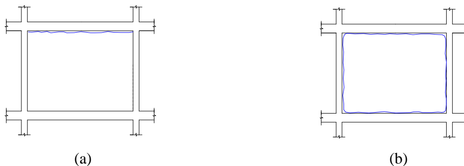
Figura 16: (a) retração da argamassa utilizada no encunhamento; (b) ação conjugada da contração e dilatação térmica resultando o descolamento entre o painel de alvenaria e a estrutura reticulada de concreto.
