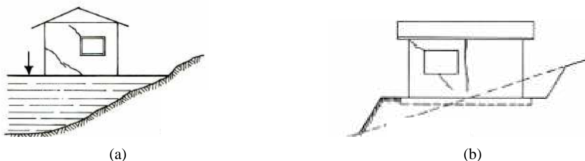
Figura 20- (a) recalque diferenciado, por consolidações distintas do aterro carregado; (b) fundações assentadas sobre seções de corte e aterro gerando fissuras de cisalhamento nas alvenarias.
