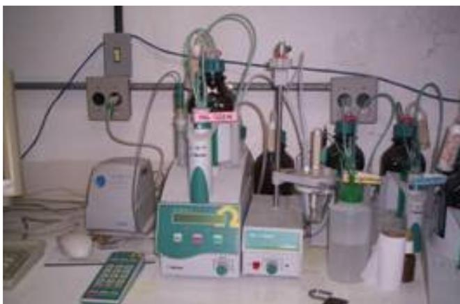
**Figura 3-4: Titulador automático utilizado para análises de cromo**
