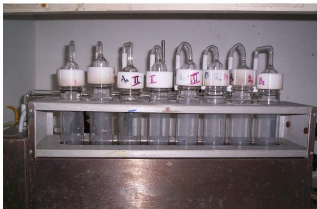
**Figura 3-5: Bloco digestor para análises de nitrogênio**
