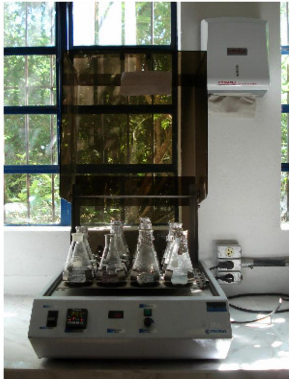
**Figura 3-3: Amostras de serragem de rebaixamento em agitador para determinação da ação de *P. aeruginosa***
