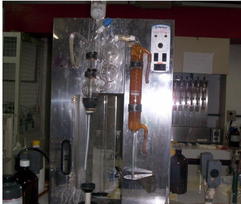
**Figura 3-6: Destilador para análises de nitrogênio**
