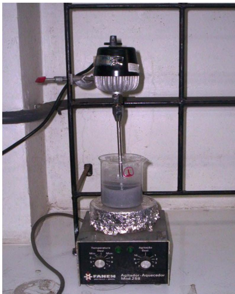
**Figura 3-2: Experimento para determinação da ação de enzima em serragem de rebaixamento com agitação e temperatura controlada**
