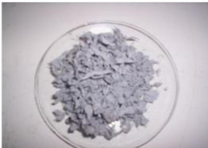
**Figura 3-1: Serragem de rebaixamento**
