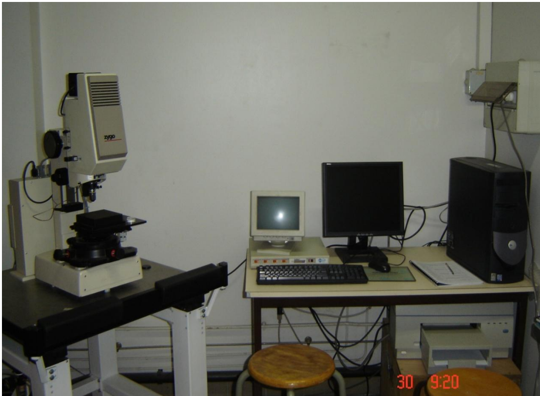
Figura 12: Interferômetro utilizado para análise da rugosidade dos revestimentos de zinco e zinco compósito.
