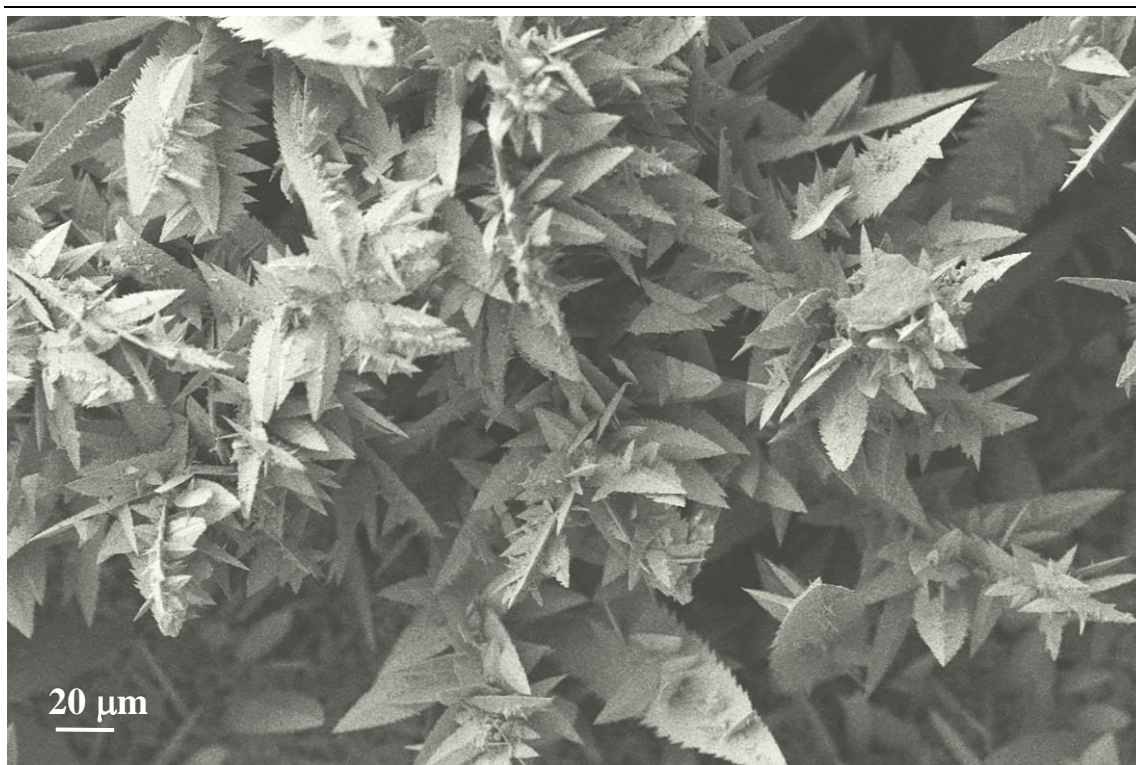
Imagem MEV das estruturas em forma de folhas de ouro eletrodepositadas sobre EIC.
