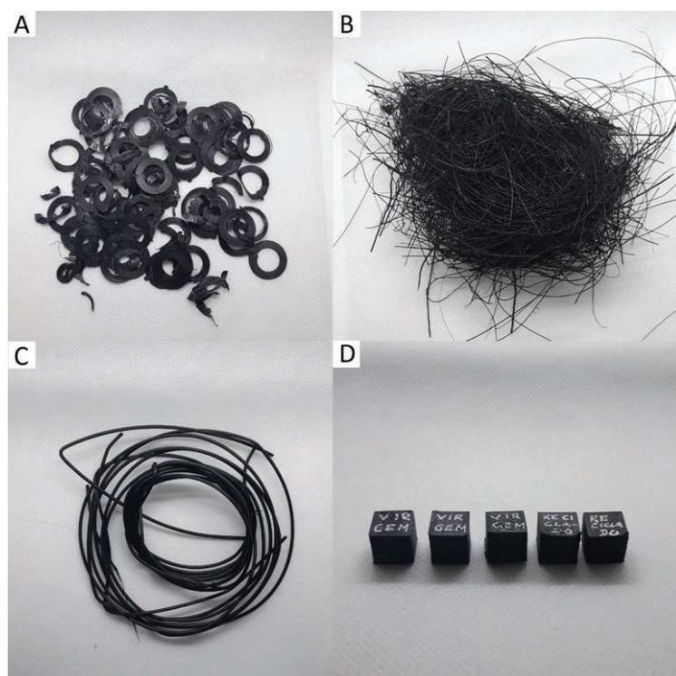
A) Discos de calibragem. B) Filamento extrudado purgado. C) Filamento excluído. D) Testagem de parâmetros.
