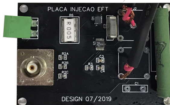
Figura 25 – Placa montada do injetor de EFT.
