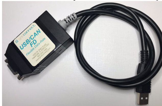
Figura 40 – Hardware Grid Connect para análise da comunicação em CAN-FD.
