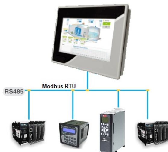
Figura 2 – Exemplo de rede Modbus.
