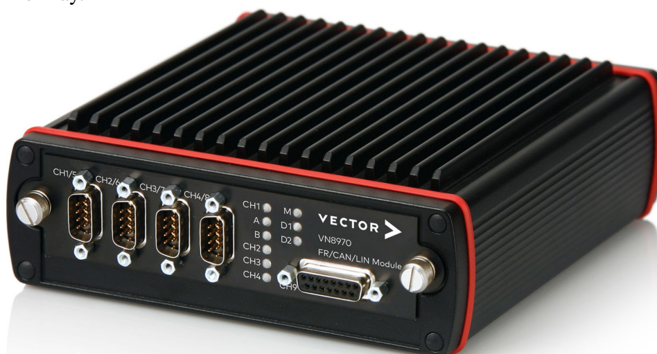
Figura 53 – Hardware da ferramenta CANoe da Vector, utilizada nos ensaios com o protocolo FlexRay.
