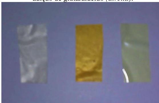
Alguns filmes de lactose apresentaram bolhas aparecem durante a reticulação a 105°C. É possível que porções do filme tenham grudado na placa (mesmo ela estando protegida por Teflon) e, devido ao calor, o material expande, formando a bolha, conforme mostrado na Figura 82.
