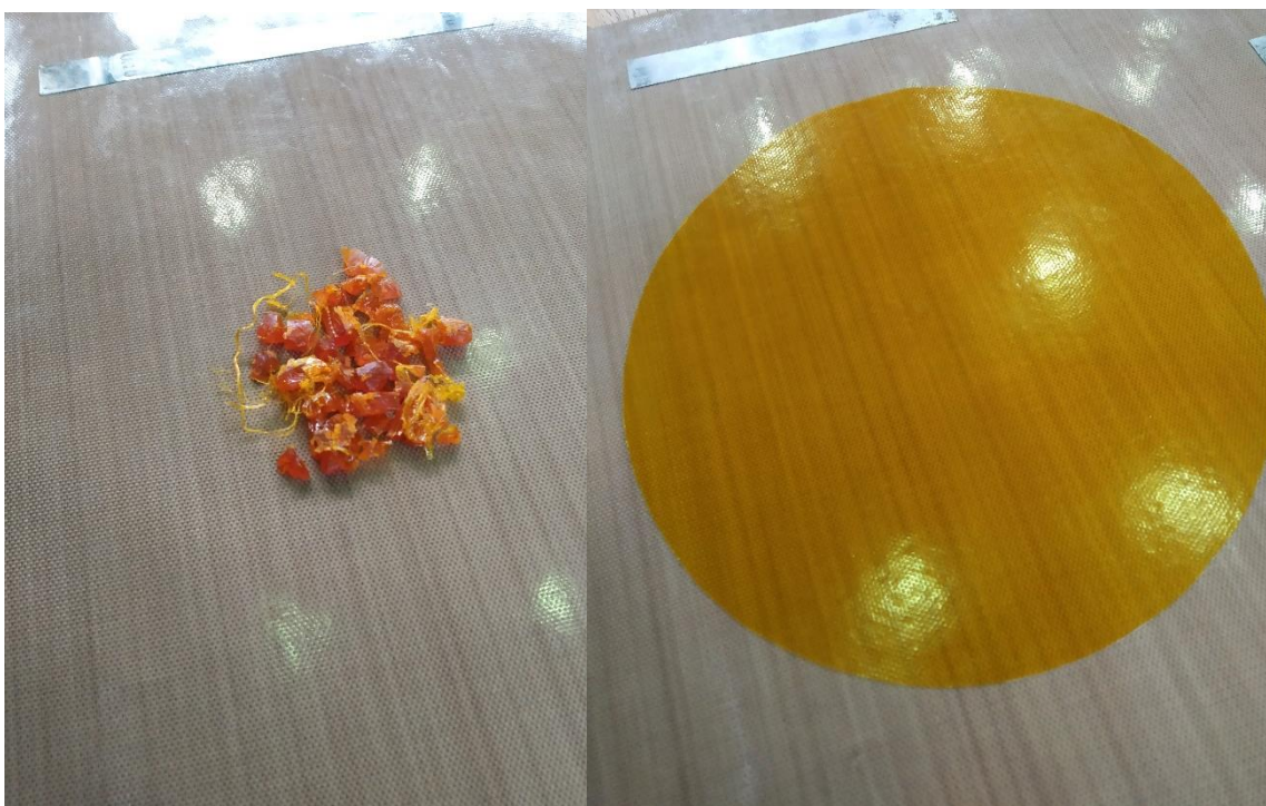
Figura 7. Polímero obtido por fusão em câmara de mistura antes (esquerda) e após a termo-compressão (direita)
