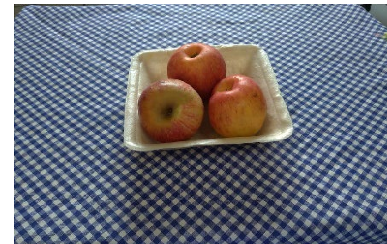
Bandejoca: bandeja expandida criada com fécula de mandioca, água e glicerol.
