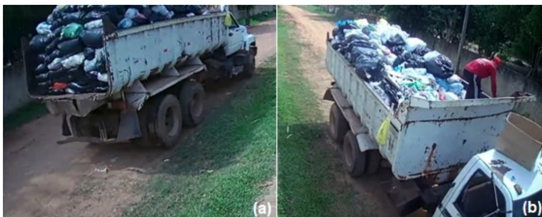
Figura 31 – (a) Veículo de coleta de resíduos sólidos sem tampa traseira e (b) equipe de coleta de resíduos sólidos do município de Itacoatiara-AM dentro da caçamba do caminhão em contato com os resíduos
