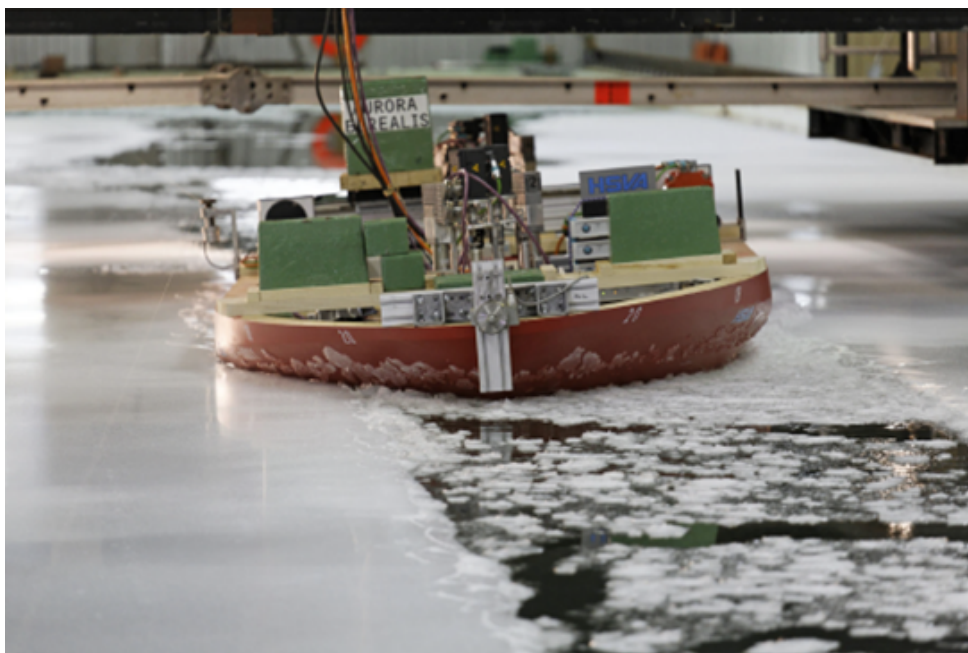
Figura 3.1 – Modelo em escala da embarcação quebra-gelo [Lembke-Jene et al., 2011].
