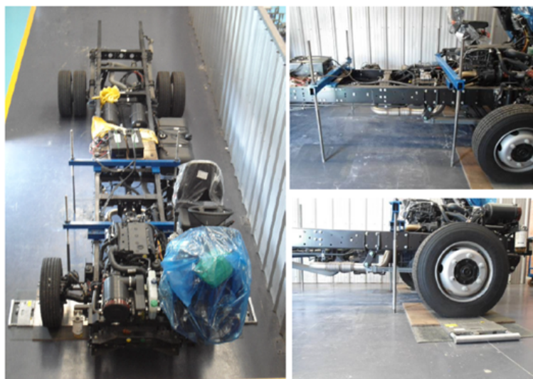
Figura A.5 – Chassi preparado para carregamento no eixo dianteiro.
