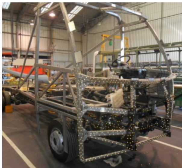
Figura A.4 – Estrutura marcada com adesivos.
