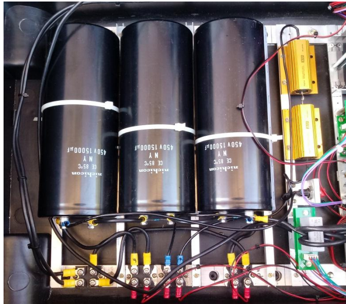
Figura 5.11 – Circuito de polarização.
