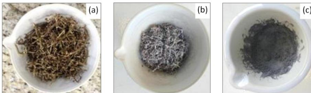
Figura 3.4: Aspecto da amostra de engaço (a) in natura , (b) após carbonização e (c) após maceração.
