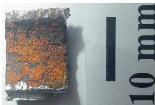
Figura 4.42 - Ponto de deposição e corrosão da amostra do tubo permutador II-C analisado por micro-sonda EDS.
