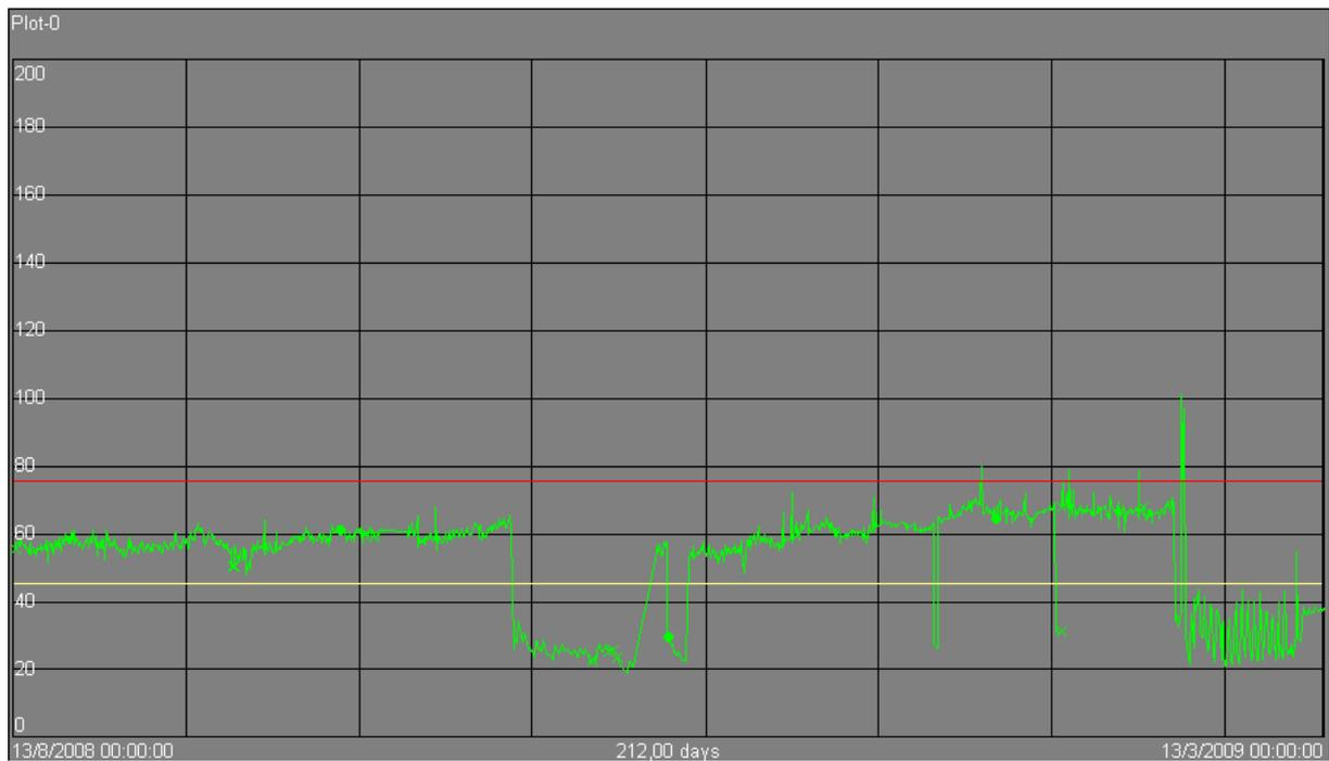
Figura 4.29 - Gráfico da temperatura de saída da água do para II-CD, limite previsto de processo (linha amarela) e de projeto (linha vermelha), de 13/08/2008 a 13/03/2009.
