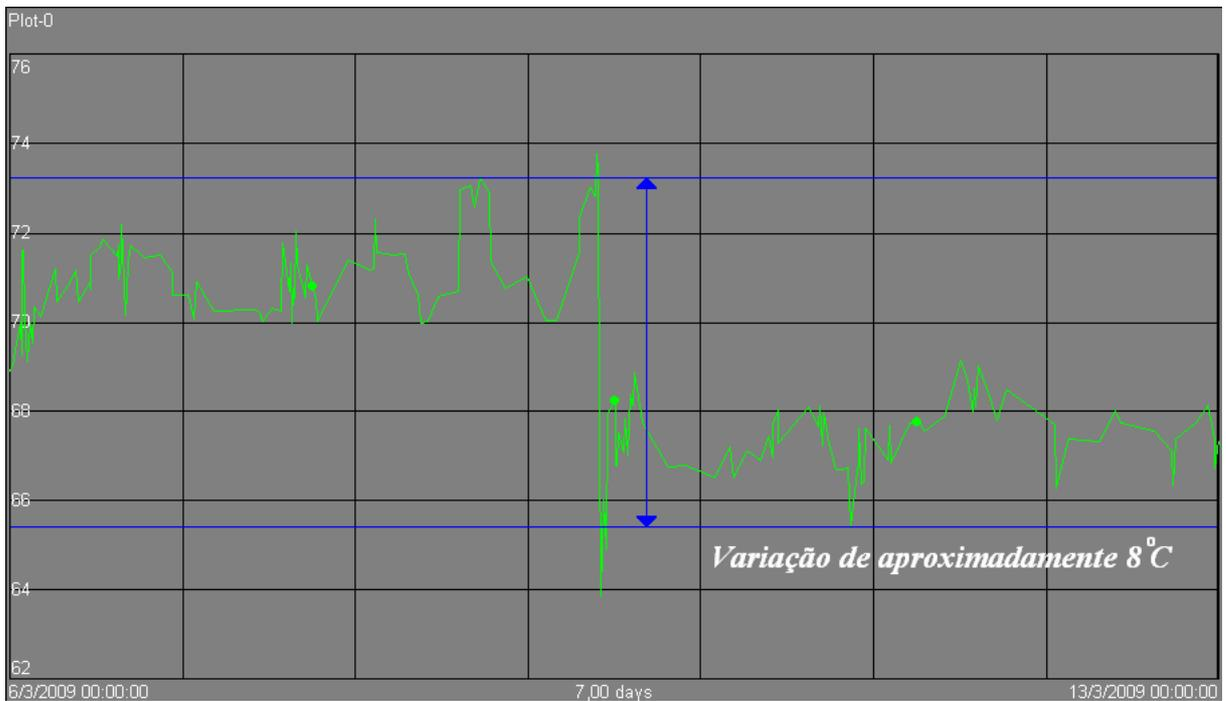
**Figura 4.26 - Gráfico da temperatura de saída da água do par II-AB e a máxima variação desta (linhas azuis), entre 06/03/2009 e 13/03/2009.**
