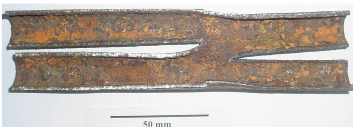
Figura 4.41 - Macrografia de um tubo do permutador II-C, mostrando corrosão interna.
