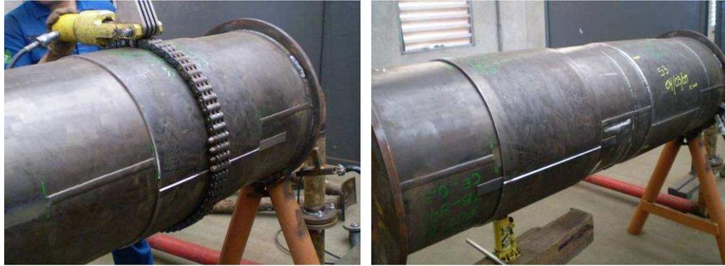
Figura 4.2: Acoplamento da dupla-calha (à esquerda) e mata-junta montado entre o tubo de teste e a junta longitudinal (à direita).
