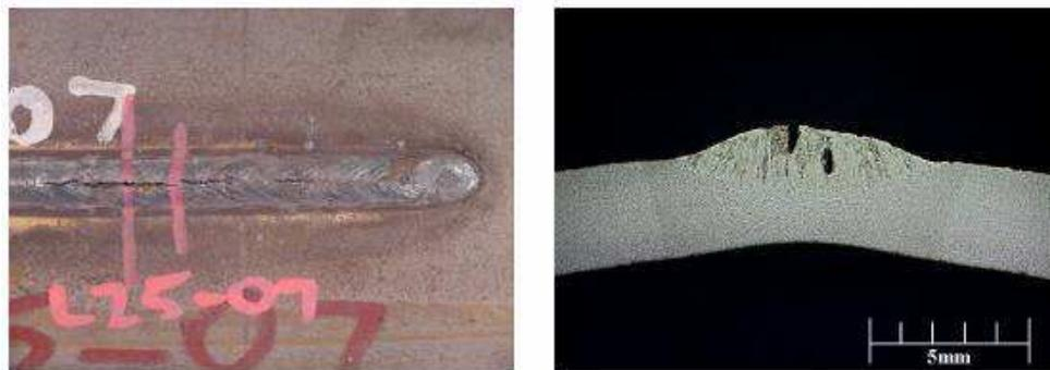
Figura 2.17: Trinca em solda *bead-on-pipe* executada na direção longitudinal. Vista externa (à esquerda) e macrografia da seção transversal (à direita). Pressão interna no tubo 8,27 MPa, energia de soldagem 0,40 kJ/mm, espessura da parede 3,2 mm, eletrodo AWS E7018 diâmetro 2,4 mm (adaptado [28]).
