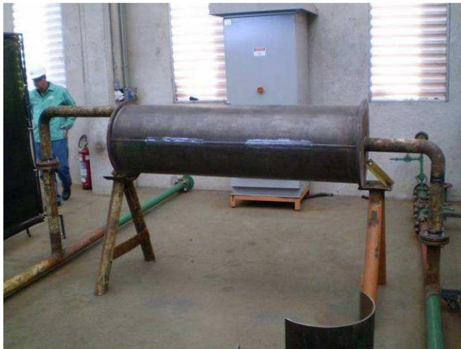
Figura 4.1: Tubo de teste montado no circuito de circulação de água e espaço físico utilizado durante as soldagens.
