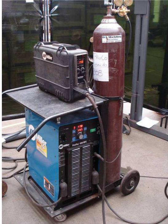
Figura 4.3: Fonte de energia Miller PipePro 450 RFC, alimentador de arame Miller PipePro 12RC SuitCase e tocha de soldagem Bernard PipeWorx 400-15.
