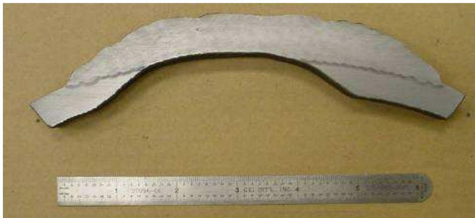
Figura 2.4: Duplo-reparo por deposição de solda [1].
