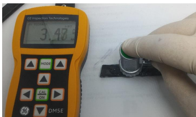
Figura 38 – Inspeção por ultrassom para identificação de trincas internas.
