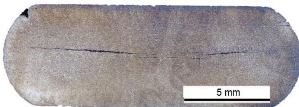
Figura 60 – Macrografia da ANR após os ensaios de carga constante, mostrando trincas na região central dos arames detectadas por US.
