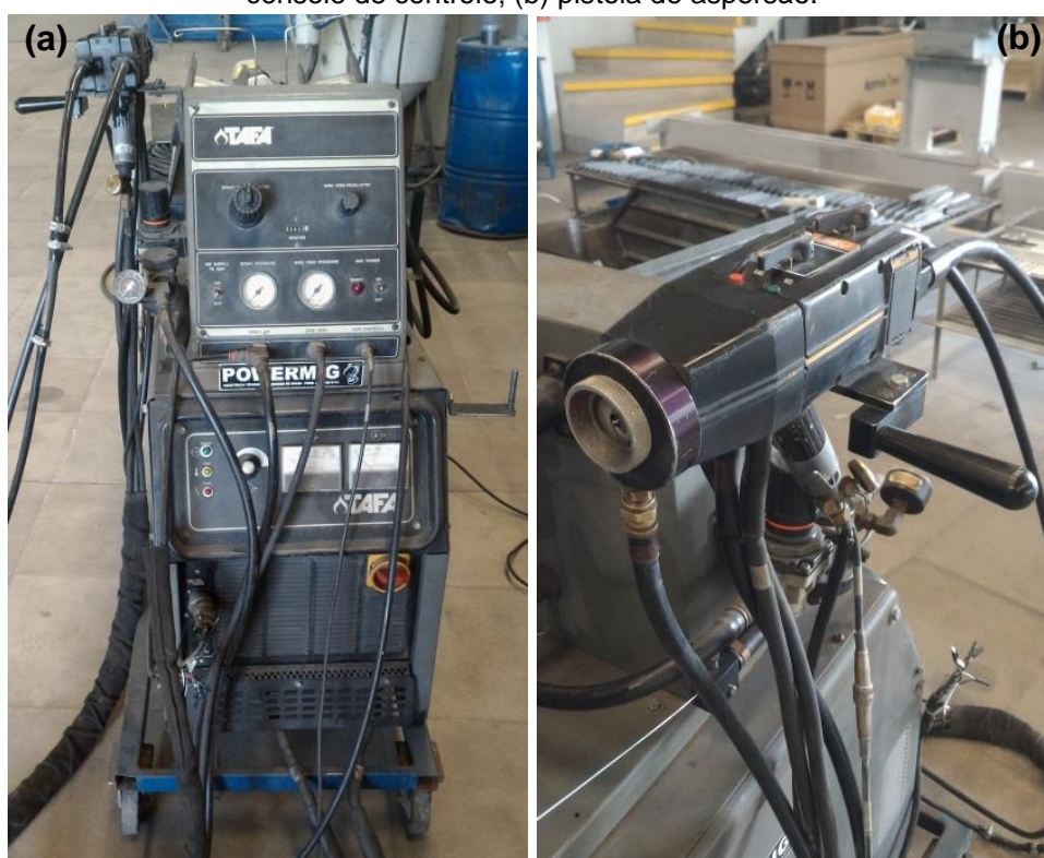
Figura 30 – Equipamento de aspersão térmica por arco elétrico utilizado: (a) fonte de energia e console de controle; (b) pistola de aspersão.
