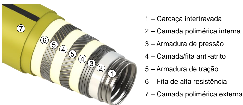
Figura 3 – Estrutura básica de um duto flexível
