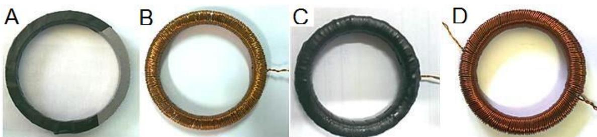
Figura 41: Etapas para montagem dos anéis para determinação das propriedades.
