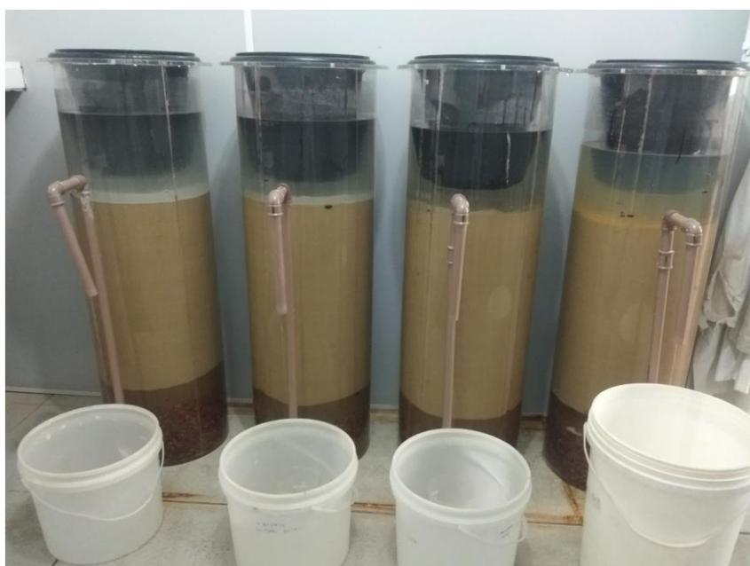
Figura 5.3 BSFs montados no laboratório de saneamento do IPH
