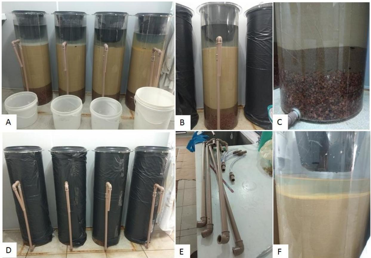
Figura 4.2 A – Os quatro BSF instalados; B – Detalhe de um dos filtros mostrando a tubulação de saída; C – Camada suporte do meio filtrante; D – Filtros recobertos com plástico preto; E – Tubos de saída dos filtros antes de sua instalação; F – Balde como prato difusor de velocidade de água de entrada.
