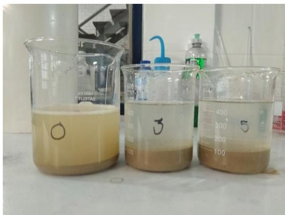
Figura 4.3 Teste para determinar quantas repetições de lavado eram necessárias.
