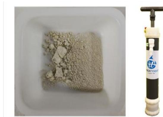
Figura 3.4 Esquerda Biofloculante e direita Sistema de membrana portátil. Fonte: POOI et al., 2018.
