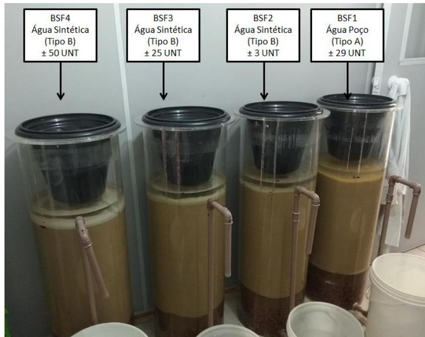
Figura 4.6 Ilustração dos BSF e respectivos níveis de turbidez
