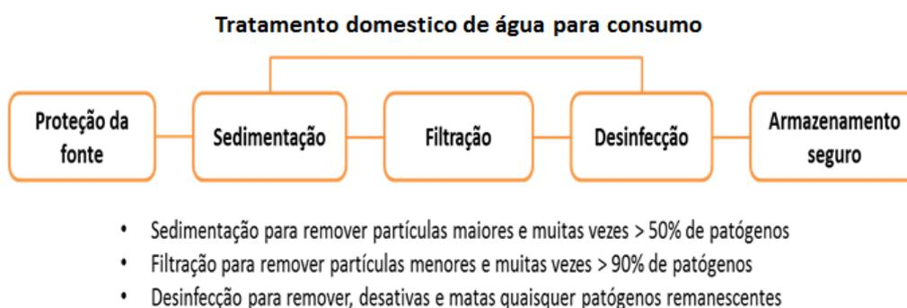
Figura 3.3 Sistema de tratamento doméstico de água para consumo. Fonte: CAWST, 2009.
