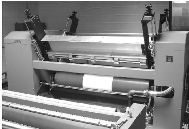
Figura 6. Equipamento para modificação superficial por chama<sup>68</sup>.
