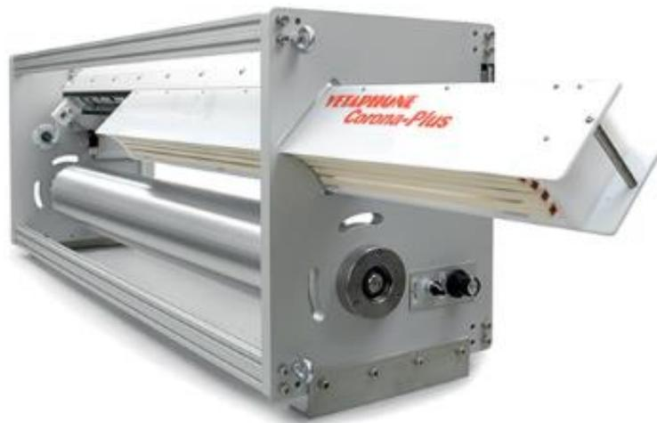
Figura 4. Equipamento industrial utilizado para descarga de corona<sup>96</sup>.
