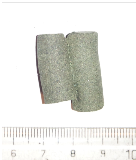
Figura 4-8. Briquetes sinterizados de minério Assmang e bentonita.
