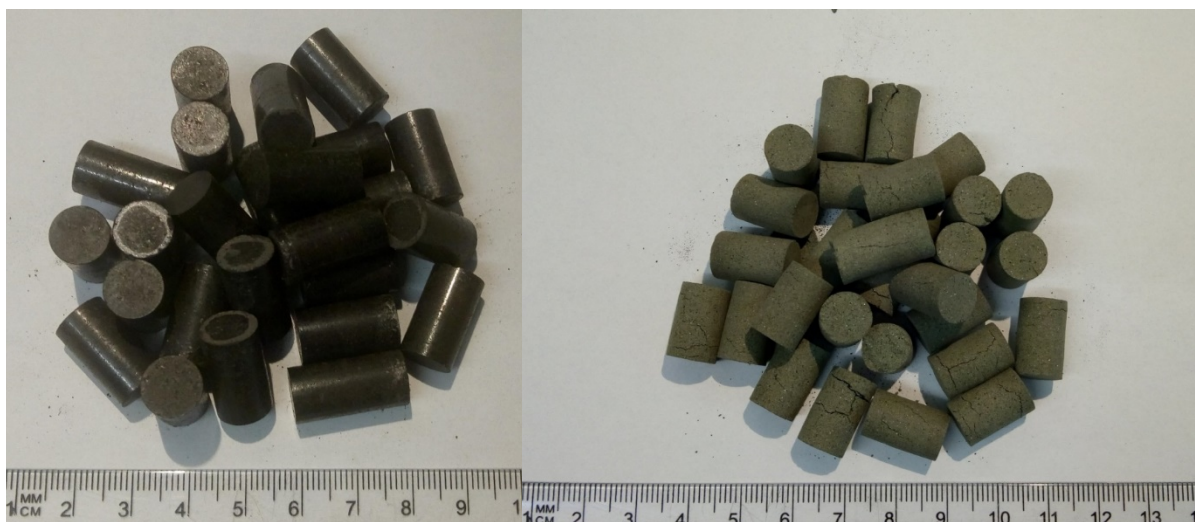
Figura 4-10. Fotografia de uma batelada de briquetes verdes (esquerda) e após o teste de redução (direita) de Comilog (< 0,250 mm) e melão.
