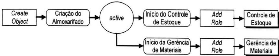
FIGURA 7.21 - Estudo de Caso: Diagrama de Transição de Estado para o Papel Básico da Classe Administração de Materiais
