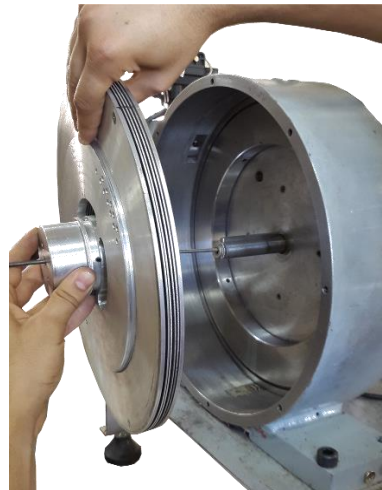
Figura 2.5 – Rotor de 4 discos junto ao eixo da turbina Tesla
