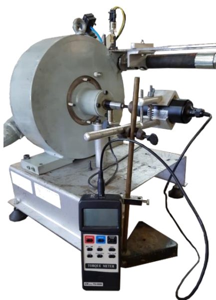
Figura 4.16 – Torquímetro instalado na turbina Tesla
