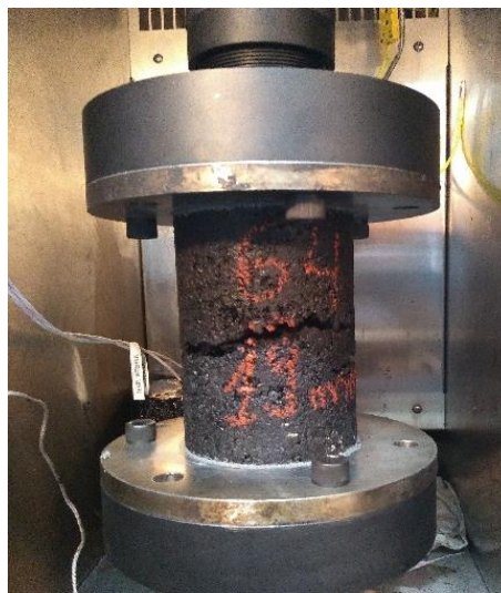
Figura 34 - Ruptura na área central
