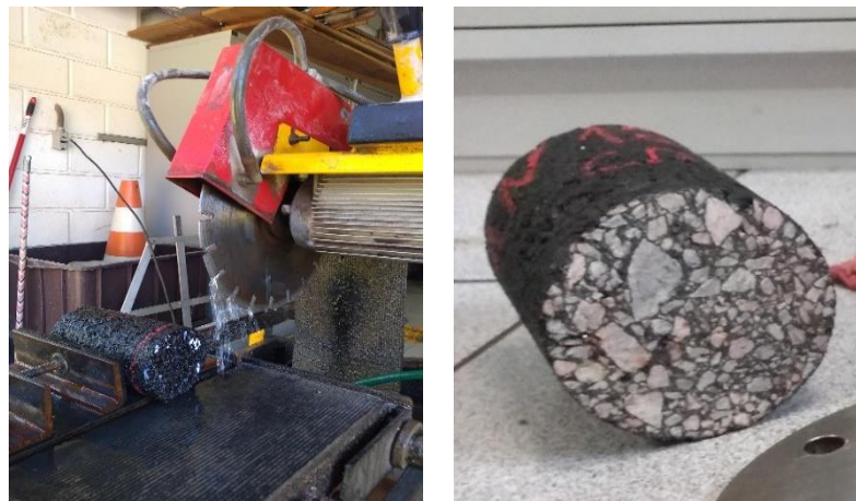
Figura 31 - Execução do corte no corpo de prova (a) e superfície serrada (b)
