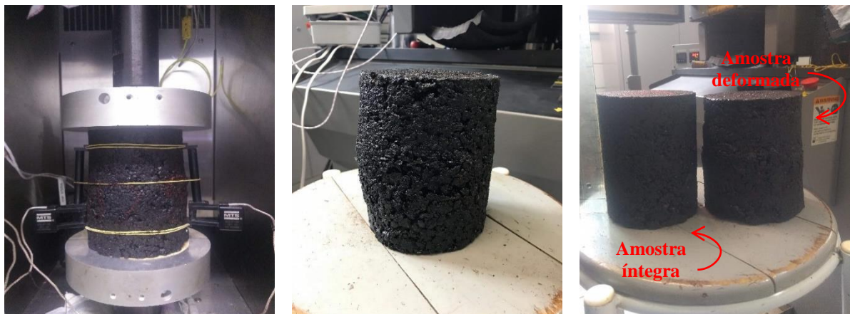
Figura 30 - Amostras deformadas após o término do ensaio uniaxial de carga repetida
