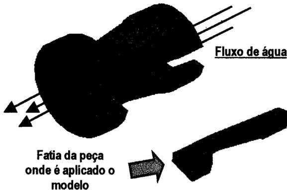
**Figura 40.** Bocal de mangueira, utilizado como peça de referência, evidenciando a fatia que será aplicada o modelo desenvolvido.
