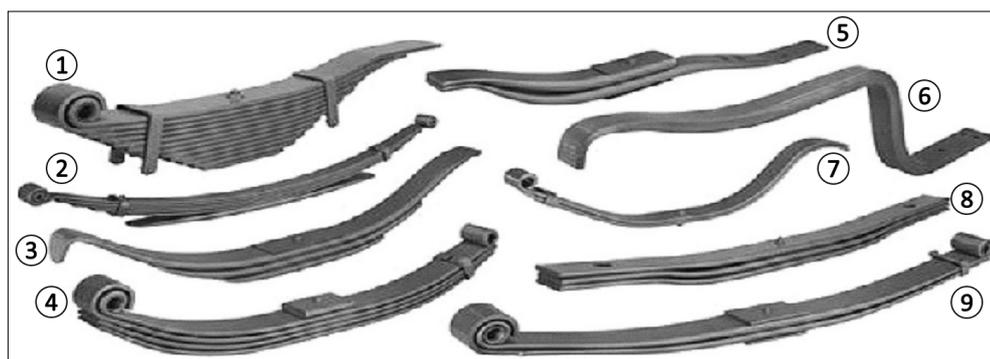
Figura 4.7 – Diferentes tipos de feixes de lâminas [adaptado de Genta e Morello, 2009]
