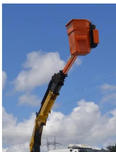
Figura 45 - Teste do sistema sem operador na caçamba.
