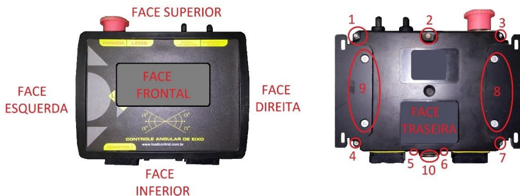
Figura 29 - Pontos de aplicação da Central de nivelamento.
