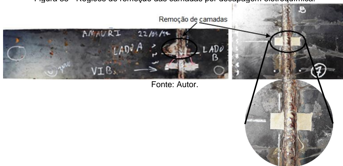
Figura 35 - Regiões de remoção das camadas por decapagem eletroquímica.
