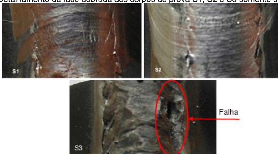
Figura 84 – Detalhamento da face dobrada dos corpos de prova S1, S2 e S3 somente soldados.
