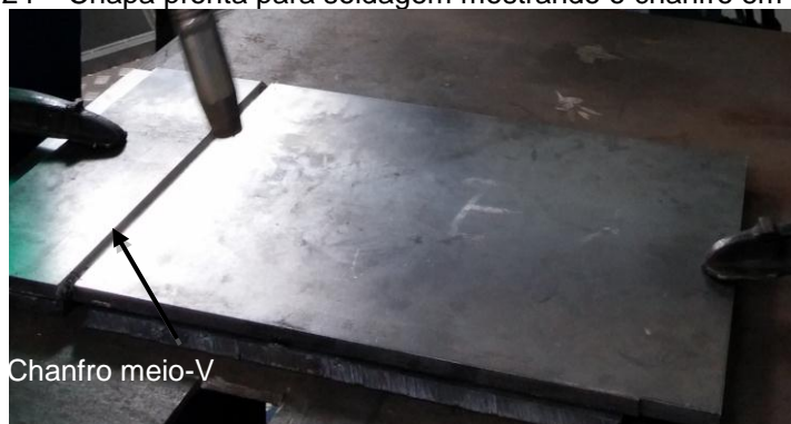
Figura 24 – Chapa pronta para soldagem mostrando o chanfro em meio-V.
