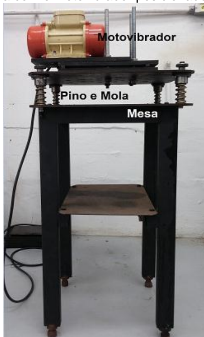
Figura 29 – Mesa vibratória com o motovibrador posicionado sobre o suporte ajustável.
