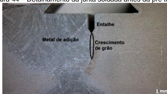
Figura 44 – Detalhamento da junta soldada antes da pré trinca.
