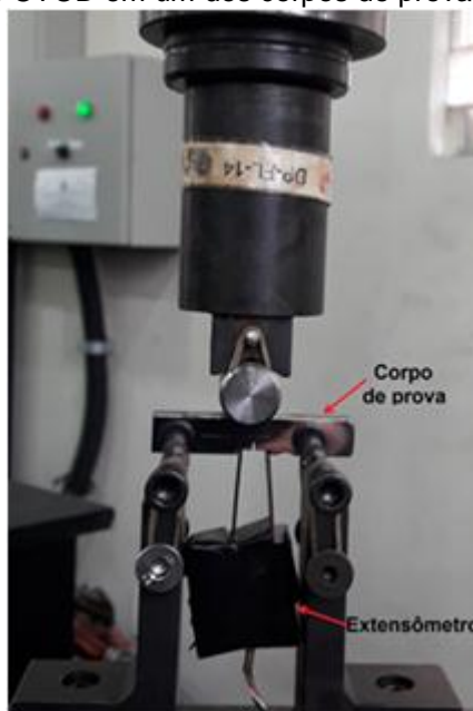
Figura 46 – Ensaio de CTOD em um dos corpos de prova na máquina MTS 810.
