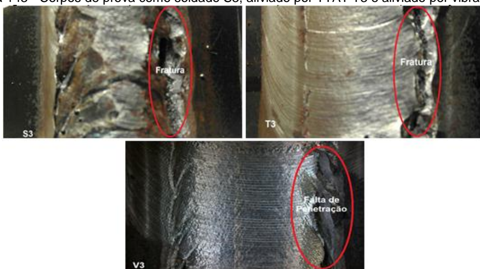
Figura 143 - Corpos de prova como soldado S3, aliviado por TTAT T3 e aliviado por vibração V3.
