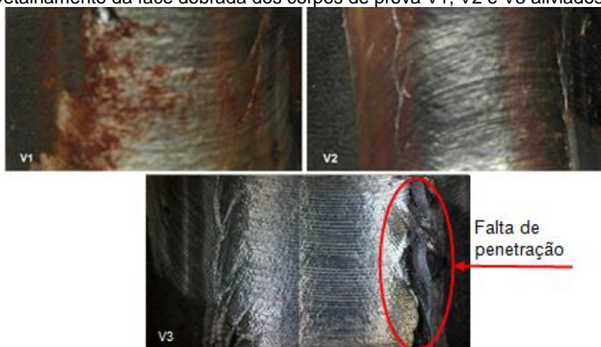
Figura 86 - Detalhamento da face dobrada dos corpos de prova V1, V2 e V3 aliviados por vibração.
