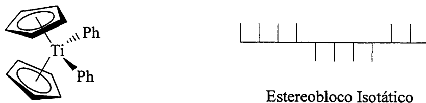
Figura I.5 Estrutura do composto \text{Cp}_2\text{TiPh}_2 e do polipropileno isotático do tipo estereobloco.
