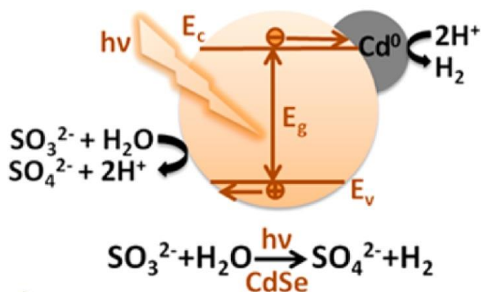
Figura 8: Representação esquemática da reação de produção de hidrogênio fotocatalisada, na presença de sulfito de sódio (Adaptado de [74]).
