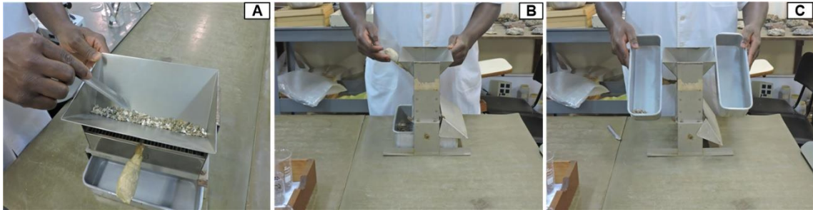
Figura 11 – Processo de quarteamento das amostras. A) Espalhamento dos sedimentos no quarteador. B) Separação das amostras para extrair uma porção representativa. C) Porções extraídas para análise.
