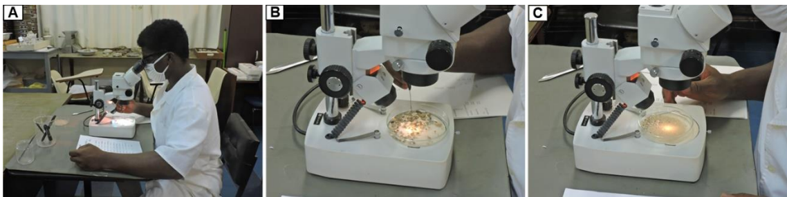
Figura 12 – A) Visão geral da análise morfooscópica dos grãos de quartzo e dos bioclastos. B) Análise tafonômica dos bioclastos. C) Análise da esfericidade e arredondamento dos grãos de quartzo.
