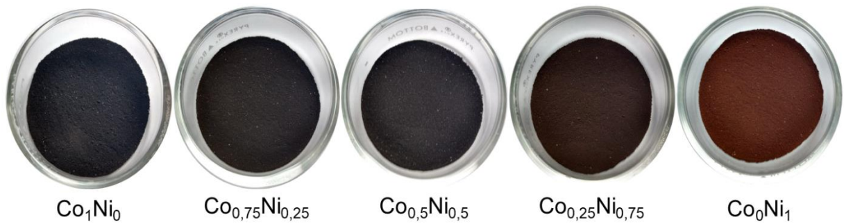
Figura 5.18 – Fotografia dos pós de ferritas obtidos após tratamento térmico a 450 °C e 3 h em função da composição química.
