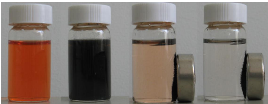
Figura 3.8 – Processo de adsorção de solução vermelho Congo em nanoferritas MnFe_2O_4 em diferentes tempos (2 min e 40 min), bem como sua posterior separação magnética. Adaptação Lixia Wang et al. [14].
