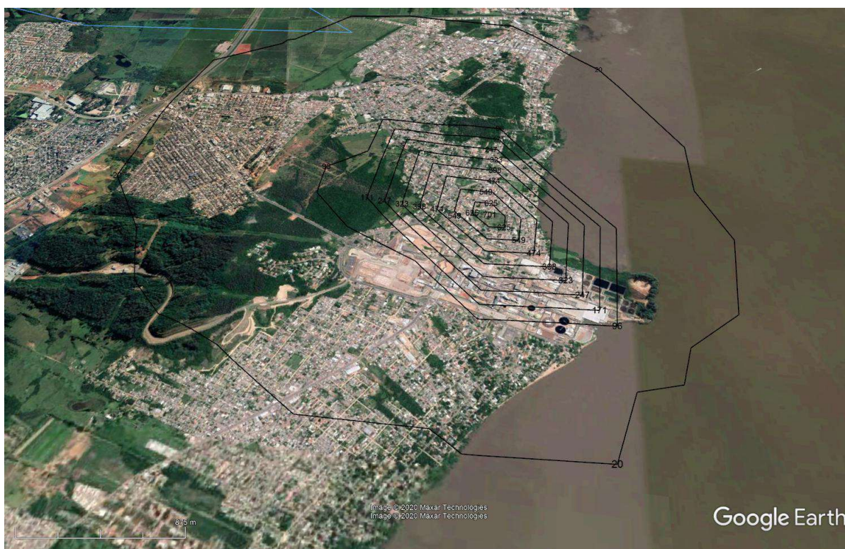
Figura 5: Imagem do Google Earth, zoom na ilustração das isolinhas de concentração de NOx ( \mu\text{g}/\text{m}^3 ), máximo de 1h para o dia 01/08/2017, no horário das 13h, dia e hora de maior concentração para este poluente
