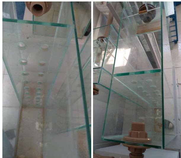
Figura 4: Decantador convencional Fonte: os autores
