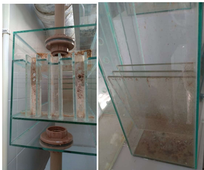
Figura 5: Decantador de alta taxa Fonte: os autores, 2020
