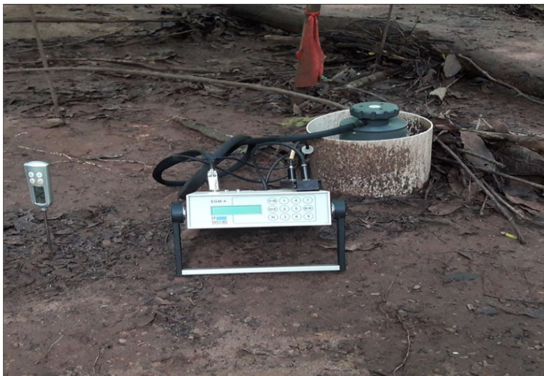
Figura 3: Analisador de gás por infravermelho portátil (EGM-4, PP Systems, U.K.), - Câmara de efluxo de CO 2 do solo (SRC-1, PP Systems, U.K.) e - Termômetro digital tipo espeto, no fragmento de Cerrado em Tangará da Serra-MT
