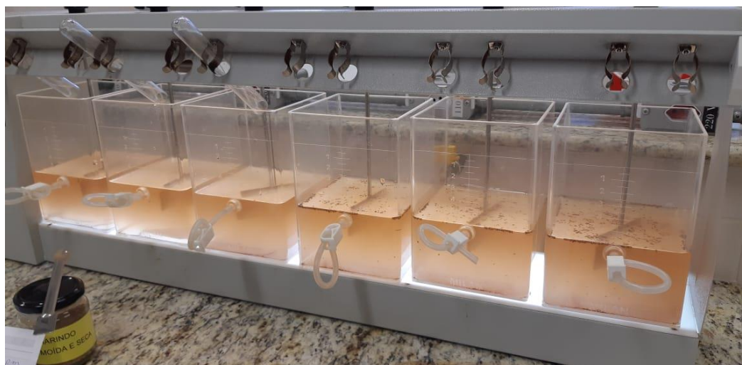
Figura 6: Equipamento Jar Test utilizado no experimento. Fonte: Autores, 2019.
