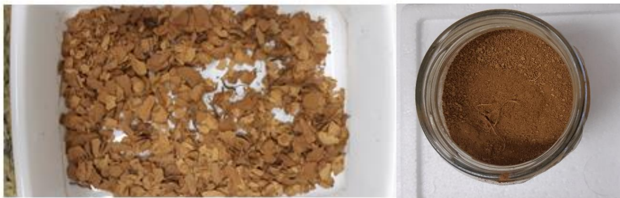
Figura 4: Casca do Tamarindo triturada manualmente e depois da trituração mecânica. Fonte: Autores, 2019.
