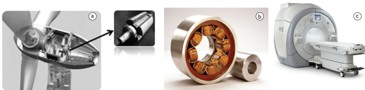
Figura 4. Aplicação dos ímãs permanentes: a) geradores eólicos, b) mancais magnéticos para compressores e c) aparelhos de ressonância magnética.
