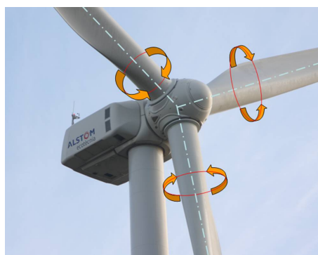
Figura 2 – Ângulo de rotação longitudinal das pás
