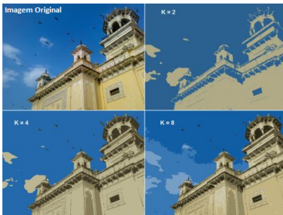
Figura 16 – Processo de segmentação utilizando algoritmo k-mean clustering com diversos valores de k .
