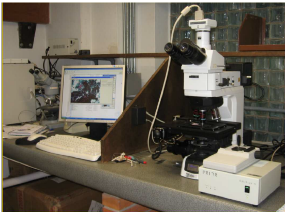
Figura 23 – Microscópio automatizado controlado pelo programa SAIMOScan.
