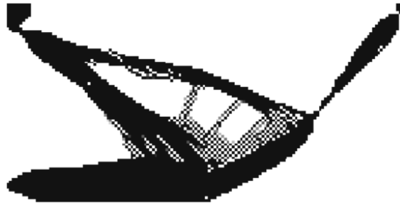
Figura 3 – Topologia sujeita a instabilidade numérica que resulta no padrão de tabuleiro. Adaptado de De Leon (2015).
