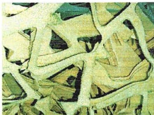
**Figura 3.7** Resíduo das placas de contraforte gerado na operação de corte das peças.
