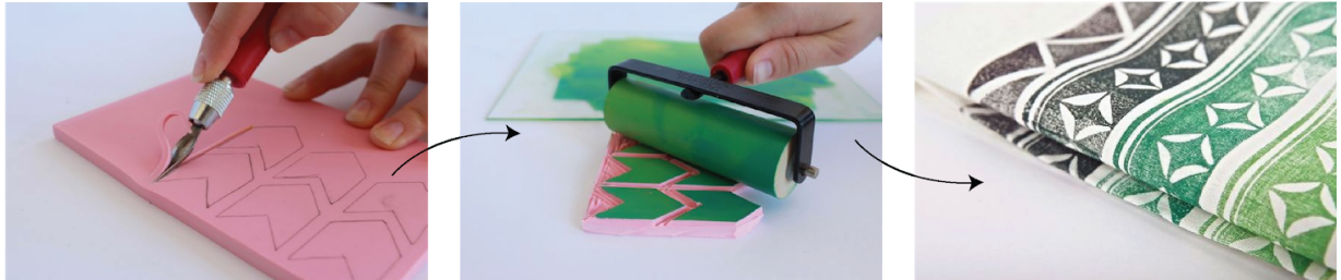
FIGURA 8. PROCESSO DE BLOCK PRINTING SOBRE PEÇA TÊXTIL.
