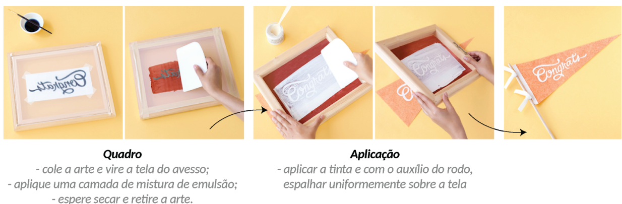
FIGURA 5. PROCESSO DE SERIGRAFIA SOBRE PEÇA TÊXTIL.
