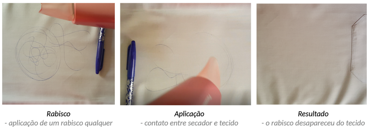
FIGURA 20. TESTE COM O USO DE UM SECADOR DE CABELO.
